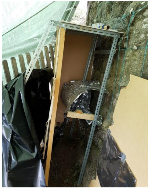
Abb. 77: Schutzvorrichtung um die UV-c-Lampe, deren Strahlung für 48 Stunden gegen den linken unteren Bereich des Reliefs gerichtet war.
