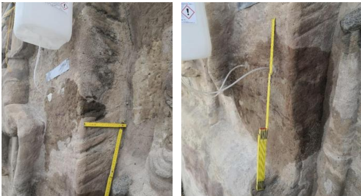
Abb. 134: Musterfläche oben rechts - KSE 300 nach 75 min des Saugens (li.) und in Folge des Nachsaugens (re.)
