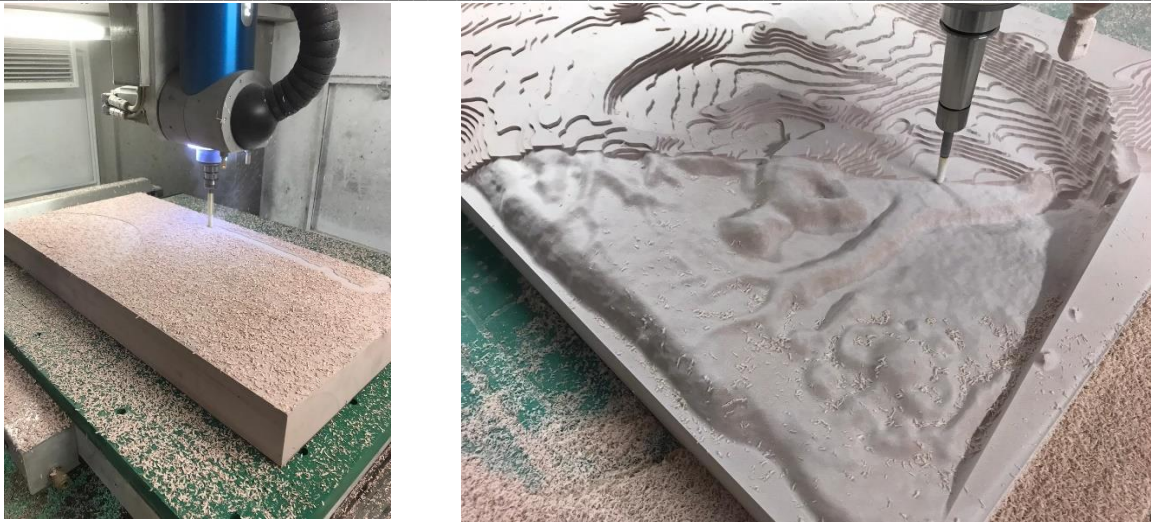
Abb. 157: Arbeitsschritte beim Übertragen der 3D-Daten mittels der Frästechnik in die PU-Platte (Umsetzung Fa. Schichtwerk)
