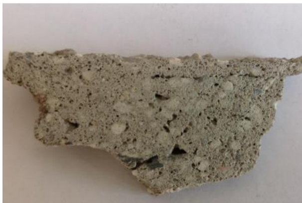
Abb. 55: Salzspeicherputzprobe mit vermutlich Bimskomponenten, die für eine Salzspeicherung und Gewichtsreduktion zugesetzt wurden.
