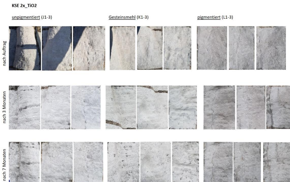
Abb. 86: Musterflächen mit zweimaligem Schlammauftrag KSE mit TiO 2 -Zusatz am Relief Fuchsjagd in einer Zeitschau nach dem Auftrag, nach 3 Monaten und 7 Monaten.
