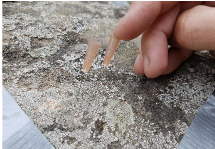
Abb. 71 und 72: Das Gestein unterhalb des Flechtenbewuchs ist vermutlich durch die Aktivität der Hyphen bereits sehr stark entfestigt. Skalpell (71) und Kanüle (72) sind leicht einzustecken.
