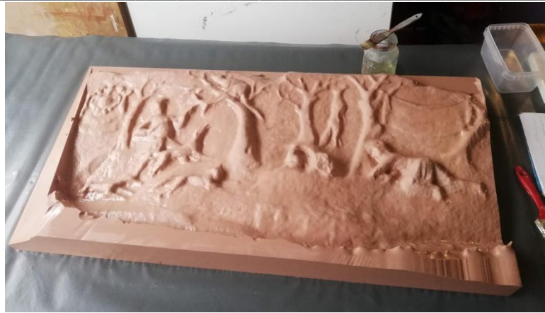
Abb. 159: Geprägtes Relief aus dem PU-Block, eingepinselt mit dem Trennmittel, vor Aufbringen der Silikonschicht
