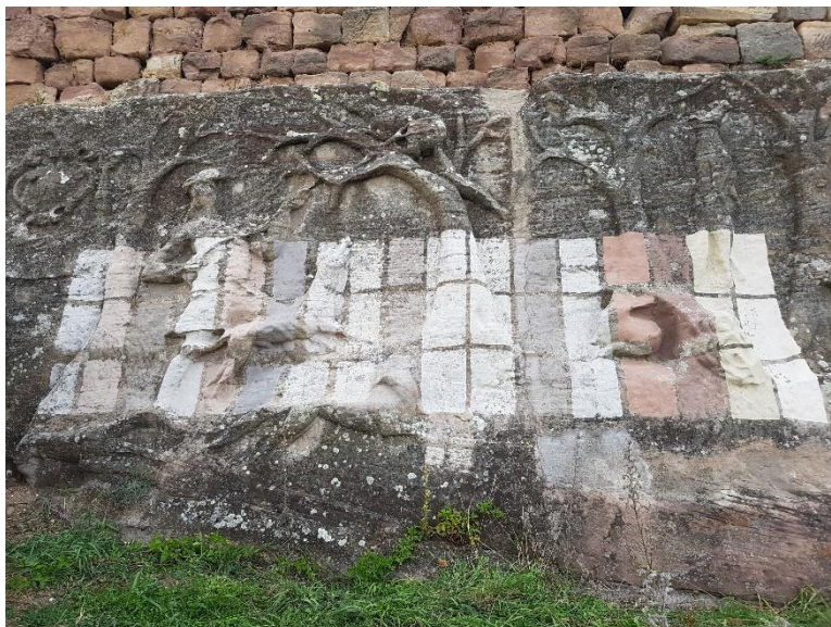
Abb. 84: Musterflächen mit den unterschiedlichen Schlämmrezepturen am Relief Fuchsjagd
