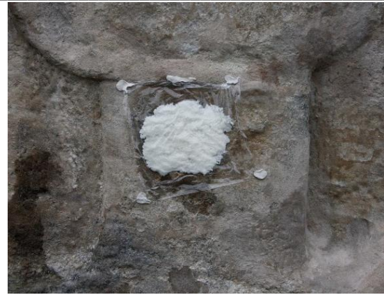
Abb. 105: Musterfläche mit Ammoniumkarbonat im li. Bereich des Reliefs Herzog Christian , im saugfähigen Bereich mit fester, zäher, leicht pusteliger Oberfläche Abb. 106: Detail aus Abbildung 105
