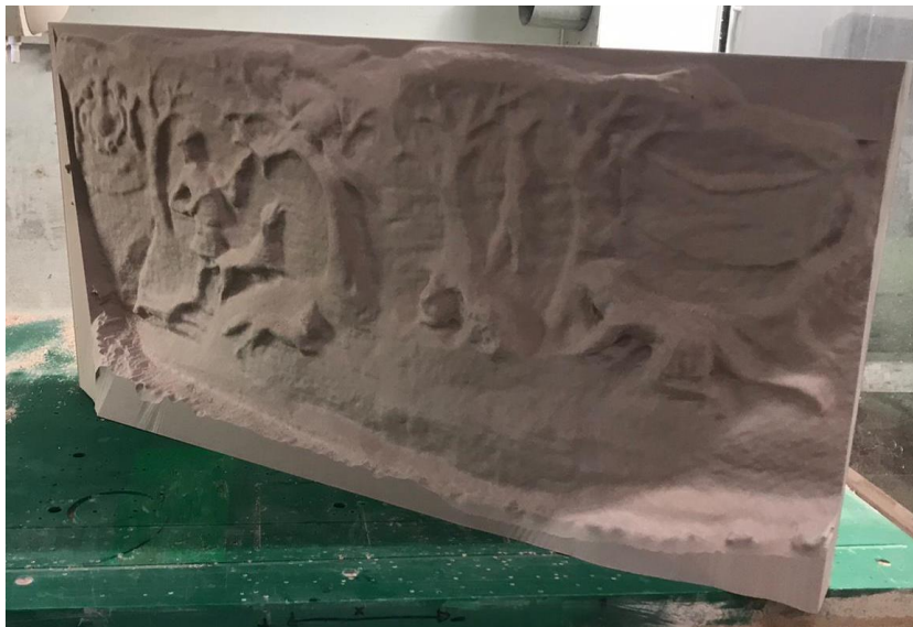
Abb. 158: Fertiggestellte, gefräste Reliefplatte Fuchsjagd . Auf dieser Grundlage erfolgte die Abformung mit Silikon und weiterhin die Kopie mit verschiedenen mineralischen Mörteln.
