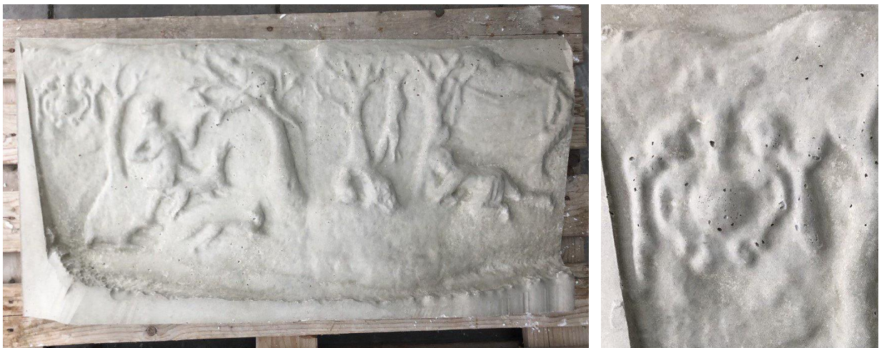
Abb. 166: Ergebnis der Mörtelmischung 3. Trotz einiger sehr kleiner Fehlstellen (rechts) sind die meisten Details präzise nachgebildet. Auch die Farbwirkung kommt dem originalen Gestein sehr nahe.
