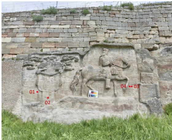
Abb. 111: Bohrwiderstand. Messstellen 01-04, Relief Herzog Christian , nach dem Auftrag des Ammoniumkarbonats (MP 01): 1-1,5 mm: entfestigt (< 3 N); erhöhte Festigkeit zwischen 2-7 mm (Höchstwert 9,6 N) = abgeflachter „Gips-Peak“; „normal“ ab 7,5 mm (2,8-4,7 N)
