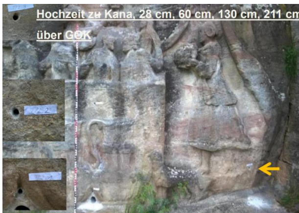
Abb. 47: Tiefenprofil des IDK am Relief Hochzeit zu Kana in 4 verschiedenen Höhen und jeweils bis in 40 cm Tiefe.
