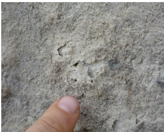
Abb. 108: Relief Herzog Christian (MP 03). Typisches Kurvenprofil für zähe feste Oberflächen, die z.T. pustelig aufspringen. Eine sehr dünne, überfeste Schicht (10,5 N) ist gefolgt von schmaler entfestigter Mürbzone (2 N) und dann dem „normal festen“ Gestein, auf sehr niedrigem Festigkeitsniveau (Werte zwischen 3 – 5,3 N).
