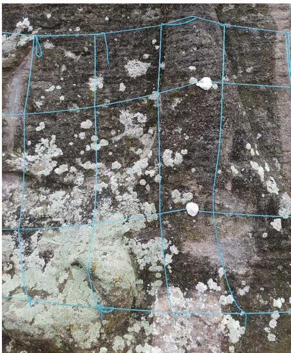
Abb. 78: Heterogen besiedelte Oberfläche mit dem Gitter, das zur Orientierung bei der Anlage der Musterflächen diente.
