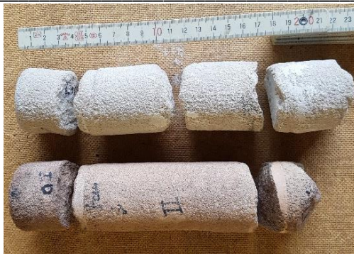
Abb. 116: Bohrkerne zweier verschiedener Varietäten, die aus den Reliefs Hochzeit zu Kana und Christus in der Kelter , jeweils aus gefestigten Bereichen entnommen wurden, um daran exemplarisch die Effektivität der Festigung von 1998/99 zu überprüfen.
