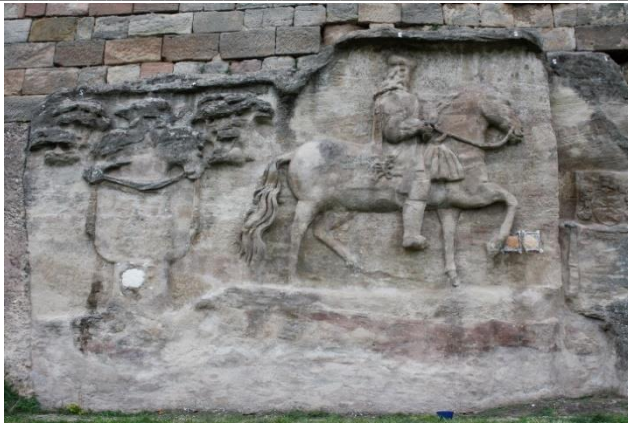
Abb. 105: Musterfläche mit Ammoniumkarbonat im li. Bereich des Reliefs Herzog Christian , im saugfähigen Bereich mit fester, zäher, leicht pusteliger Oberfläche Abb. 106: Detail aus Abbildung 105
