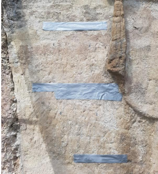
Abb. 131: Zwei Musterflächen links des Wappens – oben KSE 100 und KSE 300 unten
