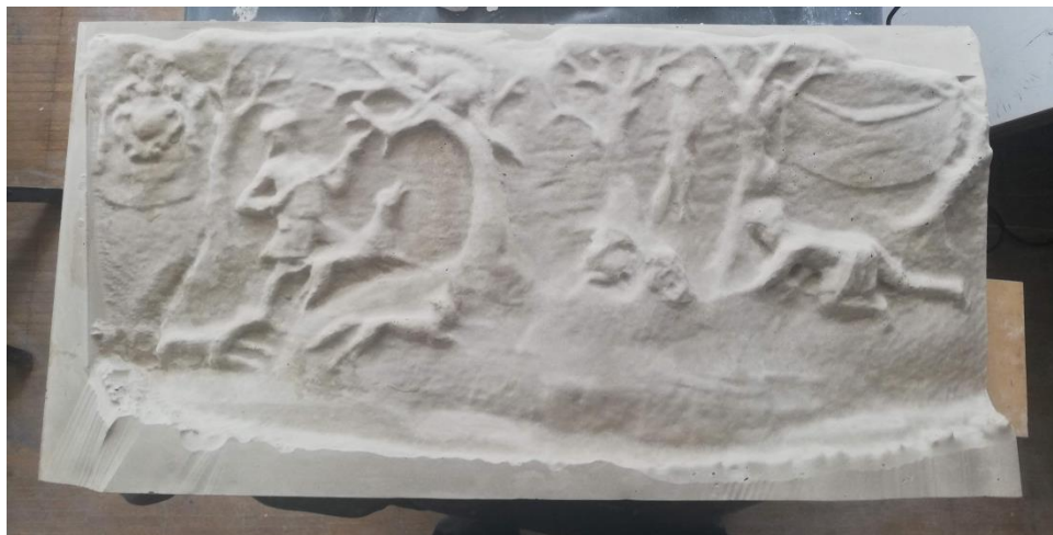
Abb. 164: Der fertige Abguss mit der Mörtelrezeptur 1. Die Abformung und der Abguss haben gut funktioniert.
