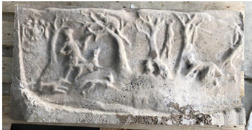
Abb. 167: Ergebnis des Abgusses mit Mörtelmischung 2. Wegen mangelnde Durchmischung gibt es massive Fehlstellen (unterer Bereich). Auch im figürlichen Bereich des Reliefs sind Luftblasenlöcher und Fehlstellen zu beklagen.
