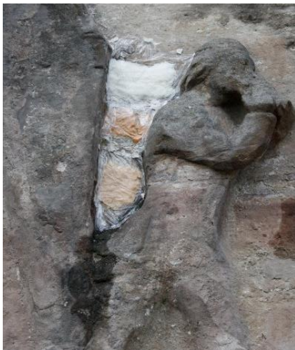
Abb. 101: Musterfläche mit Ionentauschern (u. und Mi.) und Ammoniumkarbonat (o.) im li. Bereich des Reliefs Hochzeit zu Kana , Bereich mit schlechter Wasseraufnahme
