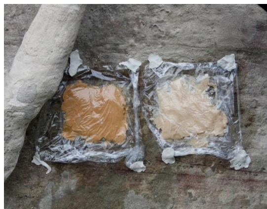
Abb. 104: Musterfläche mit Ionentauschern (li. Akeogel, re. Powdex) im re. Bereich des Reliefs Herzog Christian , im saugfähigen Bereich mit fester, zäher, leicht pusteliger Oberfläche
