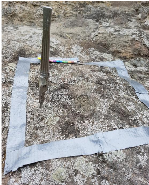
Abb. 71 und 72: Das Gestein unterhalb des Flechtenbewuchs ist vermutlich durch die Aktivität der Hyphen bereits sehr stark entfestigt. Skalpell (71) und Kanüle (72) sind leicht einzustecken.
