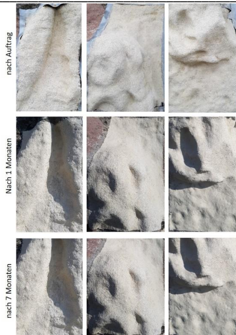
Abb. 89: Musterflächen mit ein- und zweimaligem Schlammauftrag Acrylat (ohne \text{TiO}_2 -Zusatz) am Relief Fuchsjagd in einer Zeitschau nach dem Auftrag, nach 3 Monaten und 7 Monaten.
