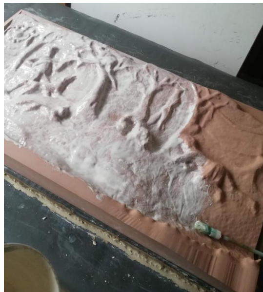
Abb. 160: Die erste, dünne Schicht der Abformmasse aus Silikonharz wurde besonders sorgfältig mit dem Pinsel aufgebracht, da hiervon die Präzision des Endergebnisses maßgeblich abhängt.
