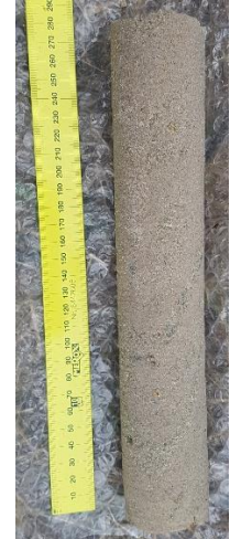
Abb. 128: Bohrkern aus dem markierten Bereich. Relativ stabiles Material.
