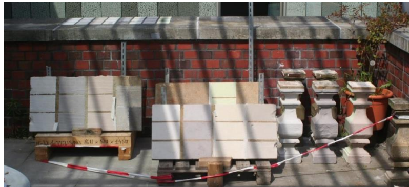
Abb. 93: Aufstellungssituation der beschichteten Probeflächen bzw. -körper, auf der Terrasse der Steinwerkstatt, ab April 2020. Im Vordergrund insgesamt 3 Platten und 3 Baluster. Im Hintergrund die beschichtete Balkonbrüstung
