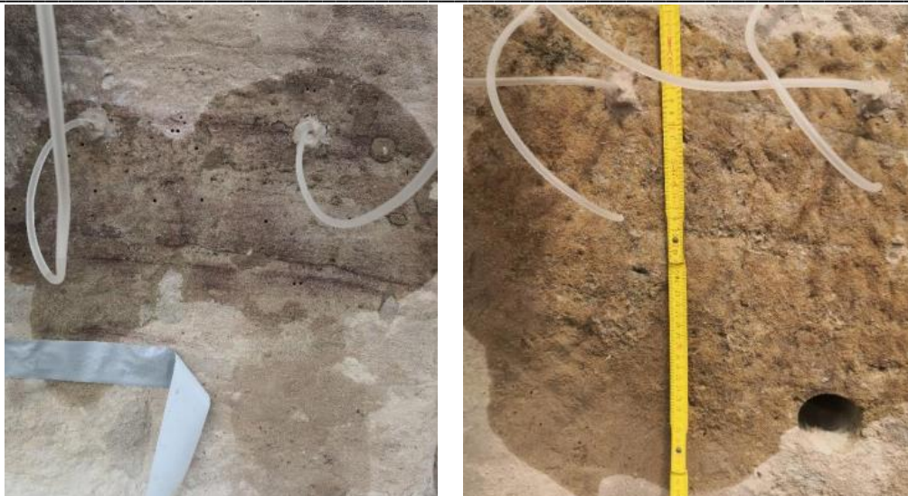
Abb. 135: Musterfläche unten rechts - KSE 300 nach 75 min des Saugens (links) und Musterfläche unten links - KSE 300 nach 75 min (rechts)
