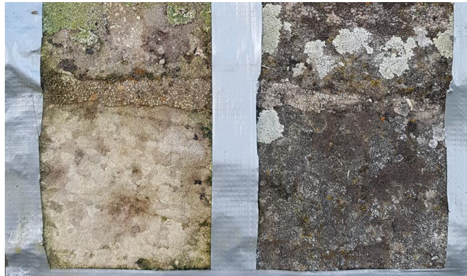
Abb. 80: Eine mit H 2 O 2 gereinigte Fläche (links) im Vergleich zur nahezu entsprechenden ungereinigten Fläche (rechts). Ein leicht fleckiges Bild bleibt zurück, jedoch kommt die originale Farbigkeit des Gesteins zum Vorschein.
