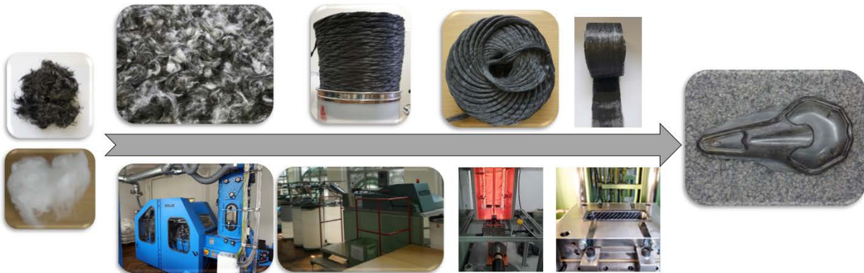
Abb. 60: Prozesskette der industriellen Herstellung von neuartigen, ökologischen und ökonomischen UD-rCF-Tapes
