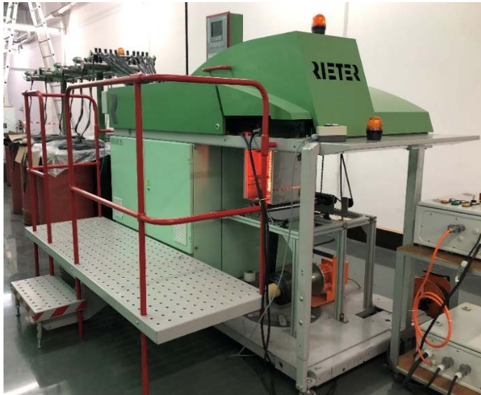
Abb. 27: entwickelter UD-rCF-Tapefertigungsversuchsstand als Prototypanlage
