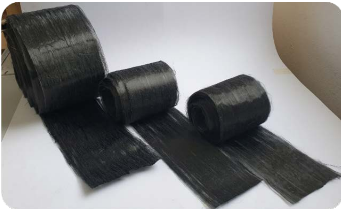
Abb. 29: hergestellte UD-rCF-Tapes mit unterschiedliche Breite und Dicke an der Tapeferigungsanlage bei Die Spinnerei Neuhof GmbH & Co. KG.
