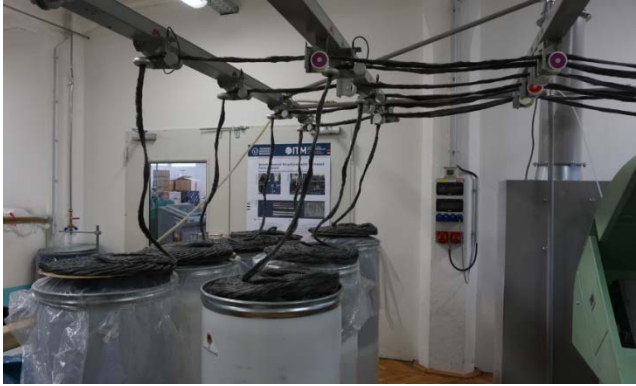
Abb. 17: Optimierung der Bandzuführung der Tapefertigungsanlage (TFA)
