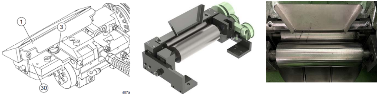
Abb. 24: Vliesführungsdüse, Bandtrichter und schmale Abzugsscheiben einer Standard-Strecke und Konstruierte und umgesetzte Abzugswalzen und Vliesführungstrichter
