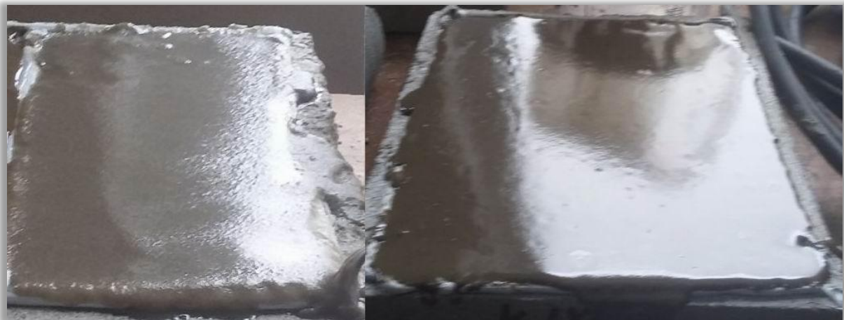
Abbildung 23: links quarzsandgefülltes Epoxidharz, deutlich zu erkennen sind die Unebenheiten, rechts betonstaubgefülltes Epoxidharz, jeweils mit einer Füllstoffbeladung von 2kg/kg.
