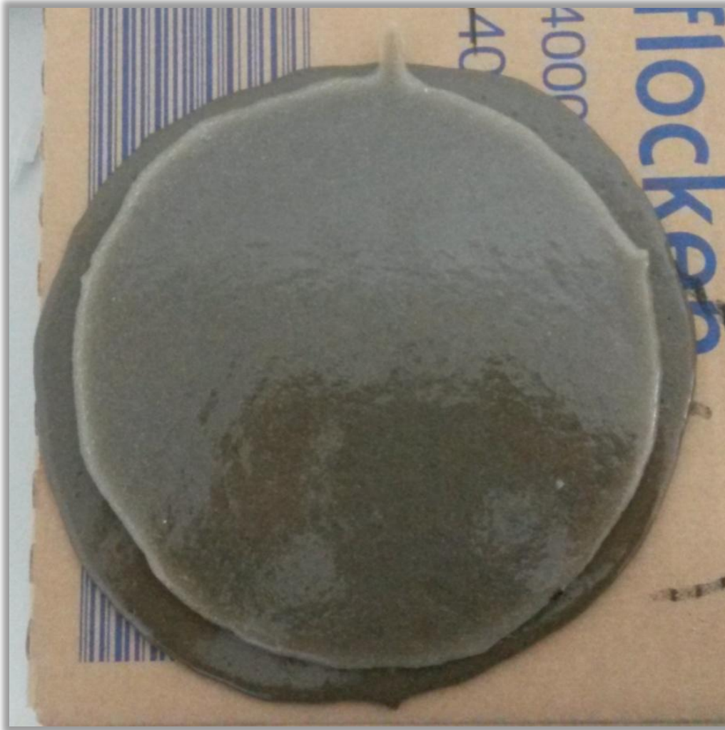
Abbildung 24: Ausbreitmaß des quarzsandgefüllten Epoxidharzes oben, Ausbreitmaß des mit betonstaubgefüllten Epoxidharzes unten im Vergleich aufeinander gelegt.
