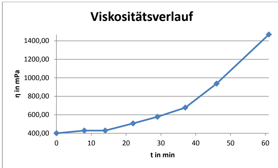
Diagramm 3: Viskositätsverlauf des Reaktionsharzes nach dem Mischen der Komponenten ohne Füllstoff.
