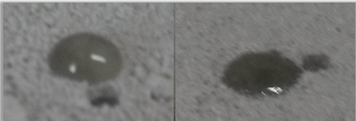
Abbildung 12: links Betonstaub mit einem Epoxidharztropfen, rechts Quarzsand mit einem Epoxidharztropfen nach jeweils 30 Sekunden.
