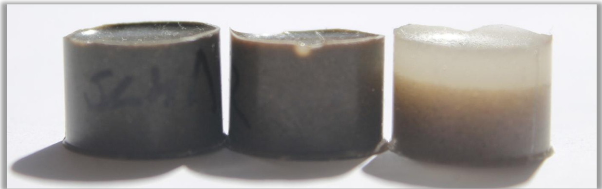
Abbildung 3: Zeigt das ausgehärtete Harz mit einer Füllstoffbeladung von 1 kg/kg, von links nach rechts: Fräsbetonstaub mit D63,2: 23,67 µm, gestrahlter Beton mit D63,2: 65,5 µm und Quarzsand mit D63,2: 180 µm Korndurchmesser.
