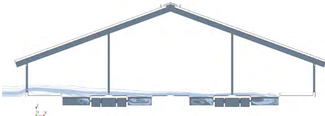
Abb. 18.: Schlierenbild mit Geschwindigkeitsverteilung im Unterflurbereich ( z = -0.55 \text{ m} ) Basis 02 in den Güllekanälen 1 - 4 (von links nach rechts)
