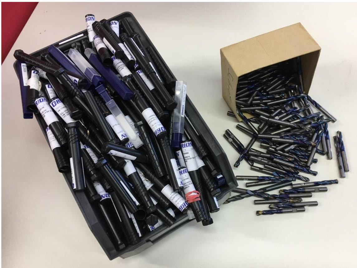
**Abbildung 1: Dokumentation Versuchsdurchführung (verschlissene Bohrer)**
