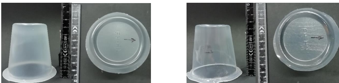
Bild 51: Schreckmarken 100 % PP-H (links) / 3 % M4 (rechts)
