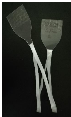
Bild 35: Geschälter Zugprüfkörper nach Belastung
