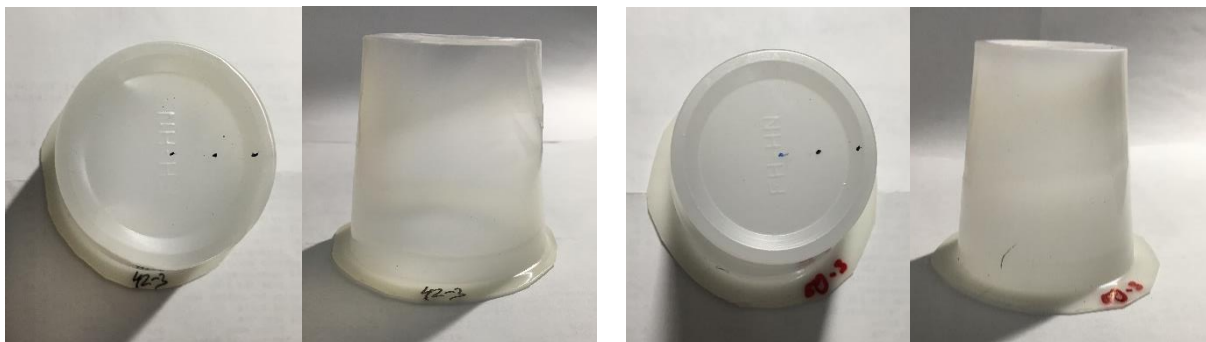
Bild 54: Bewertungsspanne für die Ausformschärfe M5 (links) / M2 (rechts)
