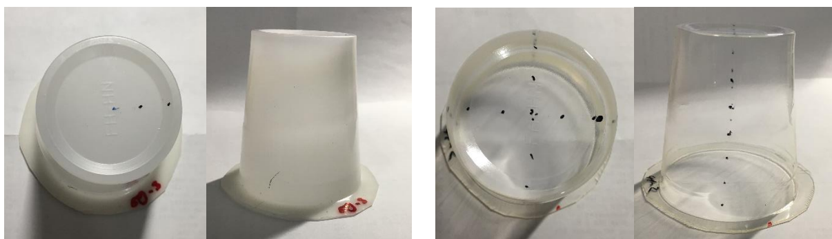
Bild 55: Bewertungsspanne für die Transparenz M2 (links) / PLA (rechts)
