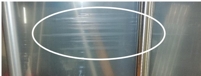
Bild 13: Riefen durch zu schnelles Abziehen auf der Oberfläche
