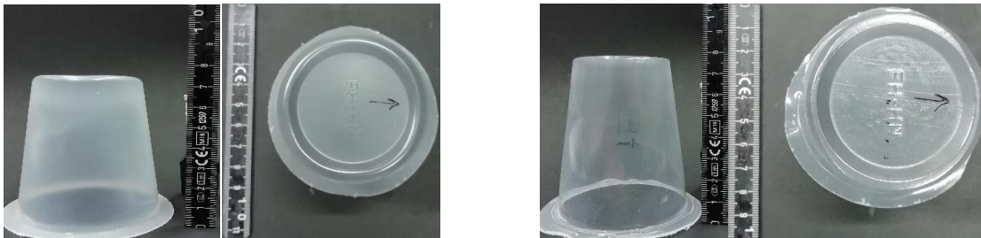
Bild 49: Transparenz 5 % M3 (links) / 5 % M1 (rechts)
