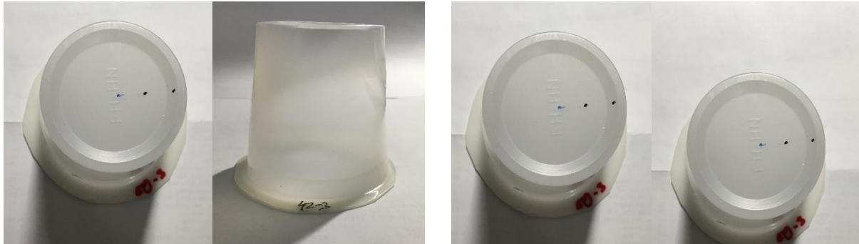
Bild 56: Bewertungsspanne für die Schreckmarken M5 (links) / M2 (rechts)
