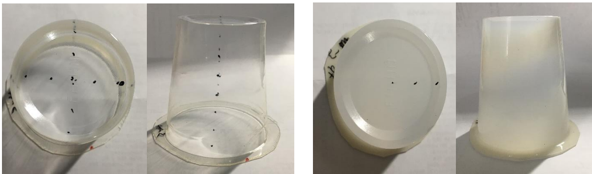
Bild 57: Bewertungsspanne für die Schlieren PLA (links) / M9 (rechts)
