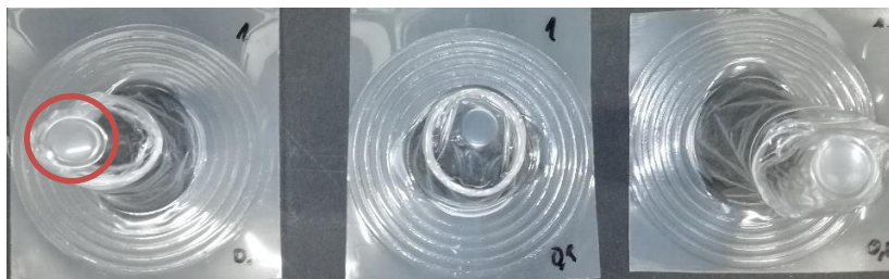
Bild 45: Materialanhäufung TMC-Versuch 0,8 mm PP-H
