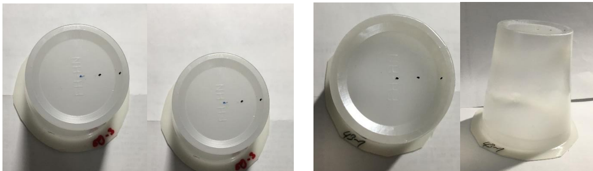
Bild 58: Bewertungsspanne für den Glanz M2 (links) / M6 (rechts)
