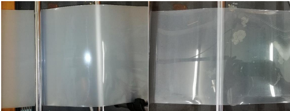
Bild 30: Qualitativer Vergleich Transparenz (links) 5 % M3, (rechts) 5 % M1 / 3 % M4
