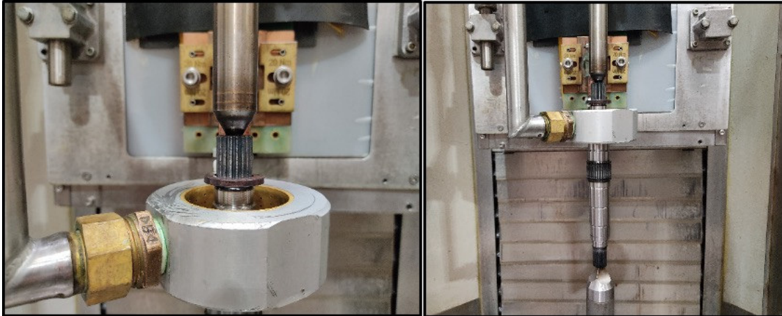
Abbildung 51: Induktionshärteanlage und Härten der Verzahnung mit d=22,3\text{mm}
