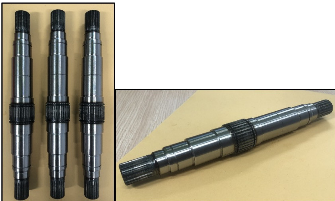
Abbildung 45: gewalzte „Innvelo“-Wellen mit den umgeformten Verzahnungen
