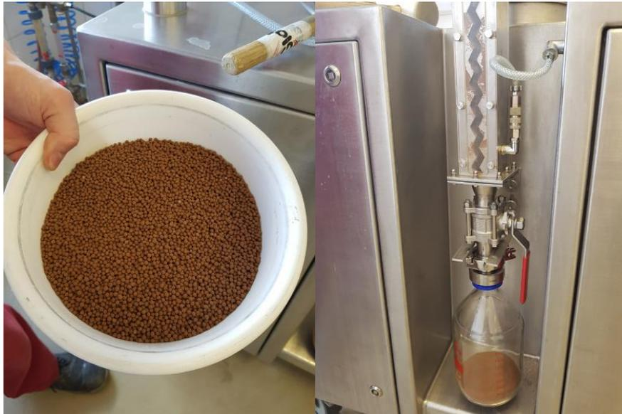
Abbildung 7: Granulationsversuche – links: Siebtrichter an Laboranlage; rechts: erzeugtes Mustergranulat
