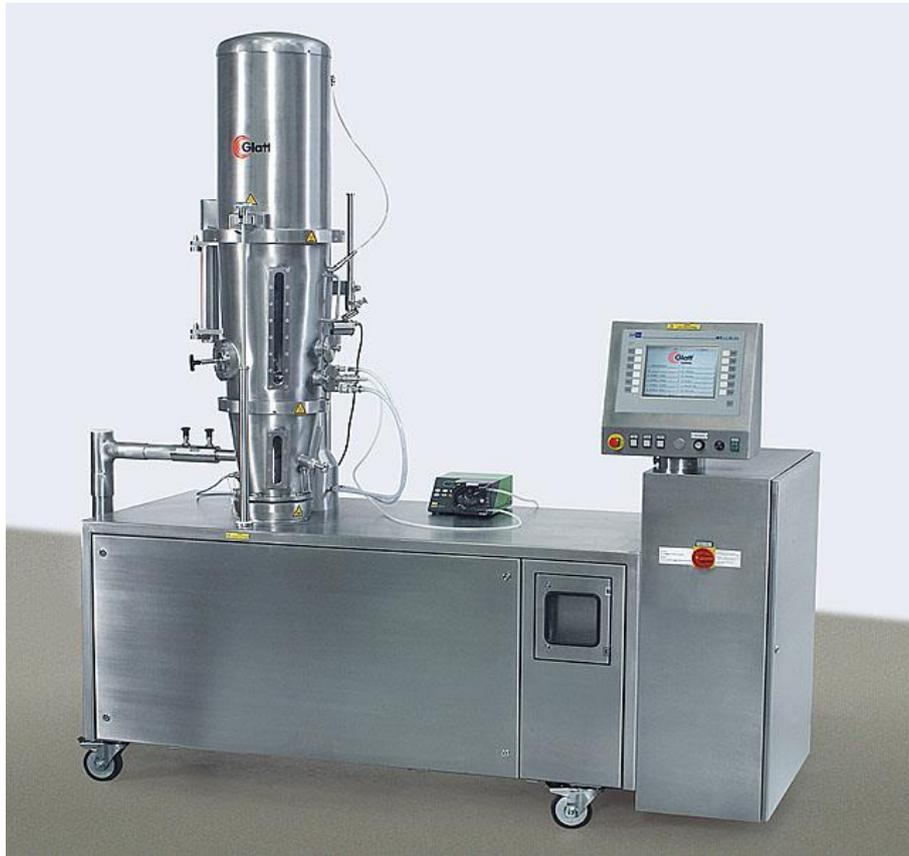
Abbildung 5: ProCell-Laboranlage für die Versuche zur Eingrenzung der Granulationsparameter für die spezifizierten Rohstoffsuspensionen
