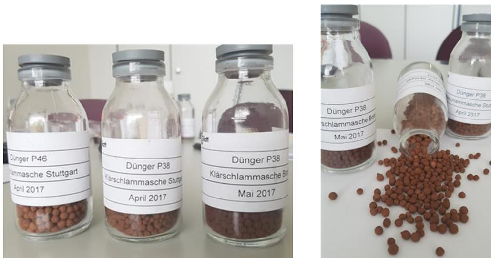
Abbildung 8: Erzeugte P-Düngergranulat-Muster – links: unterschiedliche Aschen bzw. unterschiedlicher  $P_2O_5$ -Gehalt; rechts: sehr runde, feste Granulatform der Muster
