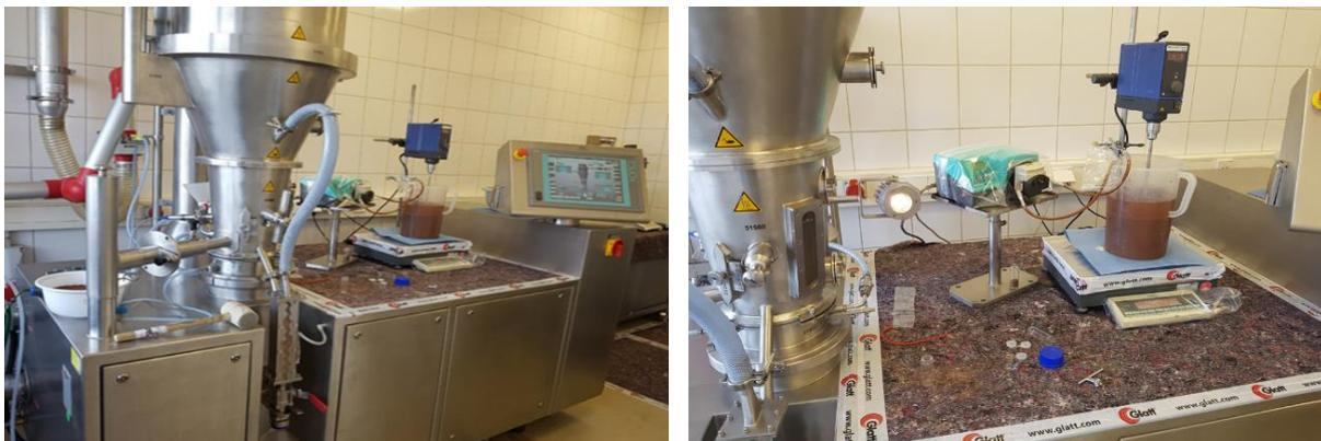
Abbildung 6: Granulationsversuche – links: Laboranlage; rechts: Die aufbereitete Suspension wurde eingedüst
