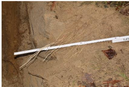
*Abbildung 84: Durchwurzelung des nicht festen ZFSV an der GOK am Baumstandort Linde*
