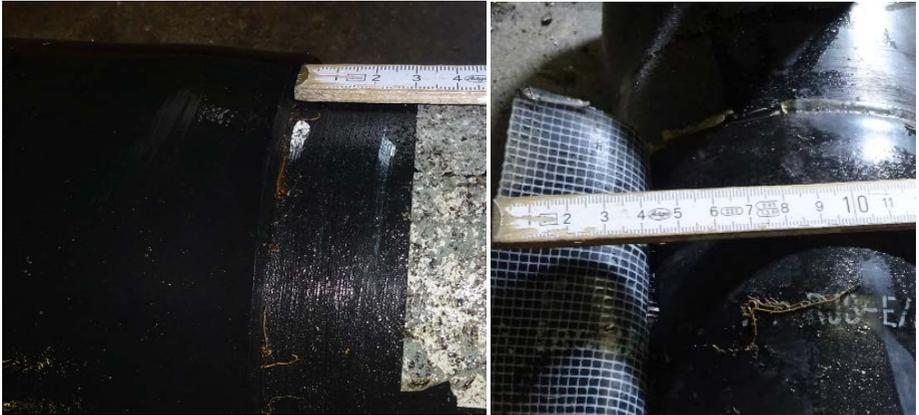
Abbildung 68: *Wurzeln am nicht mit Schmelzklebstoff ausgefüllten Spalt am Ende des Muffenrohres von Probekörper IV b (links); Wurzeln unter dem Montagepatch von Probekörper II b (rechts)*
