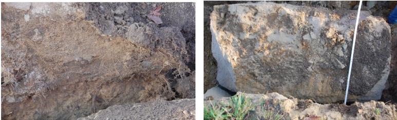
*Abbildung 80: Wurzelfilz an Grabenwand (links), umgeworfener ZFSV-Probekörper mit wenigen Erd- und Wurzelhaftungen (rechts)*
