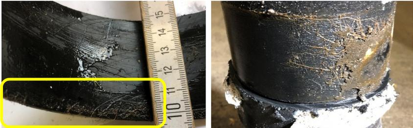
Abbildung 65: Wurzeleinwuchs in den nicht-stoffschlüssig verbundenen Spalt zwischen Muffe ohne Dichtband und Kunststoffmantelrohroberfläche (links), Wurzeleinwuchs in eine Muffenverbindung, bei der durch bewusst eingebrachte Fremdstoffe keine adhäsive Verbindung zwischen Muffenrohr und Ummantelung des KMR erfolgen konnte (rechts)
