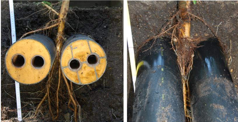
Abbildung 71: Wurzelwachstum zwischen den Rohrleitungen, Versuchskiste A, Steckling 1 (Querschnitt, links), Versuchskiste C, Steckling 2 (Draufsicht, rechts)
