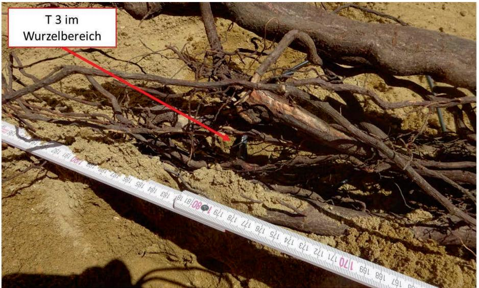
Abbildung 20: Temperatursensor im Wurzelstrang
