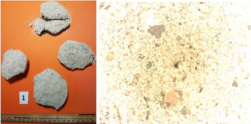
Abbildung 82: Dokumentation der ZFSV-Probestücke (links) und Aufnahme mit 5-facher Vergrößerung der ZFSV-Bruchflächen mittels Mikroskops, in der Mitte eine Auffälligkeit in Form eines schwarzen „Flecks“ erkennbar (rechts)
