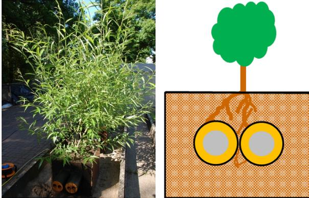
Abbildung 69: Versuchsaufbau zu Auswirkungen des Dickenwachstums von Wurzeln auf Kunststoffmantelrohre: Versuchskiste A im Mai 2020 mit ausgeprägtem Wachstum an der Oberfläche (links), Versuchsaufbauschema (rechts)
