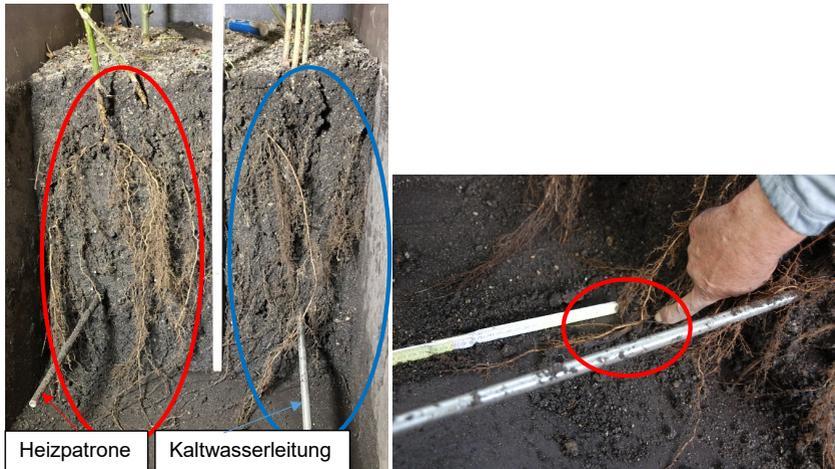
Abbildung 58: Vertikales Wachstum bis zur Versuchskistensohle auf Seite der Heizpatrone (rote Einkreisung) und auf Seite der Kaltwasserleitung (blaue Einkreisung) (links) und horizontales Wurzelwachstum an der Versuchskistensohle (rechts) beispielhaft dargestellt an Versuchskiste C - Reihe 2
