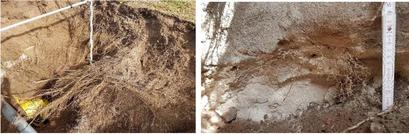
Abbildung 5: Großteil der Wurzelmasse in Baumsubstrat bis 1,5 Meter unter GOK (links) und seit 2013 vereinzelt neu gewachsene Feinwurzeln in der Bettung (rechts)
