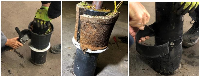
Abbildung 64: Vorgehensweise zur Öffnung der Probekörper (Links: Vertikales Aufschneiden des Blumenpotfess, Mitte: Vertikales Aufschneiden des durchwurzelten Substrats, Rechts: Entfernen der Schrumpfmanschette von der Rohroberfläche bei einer unvernetzten Muffe)
