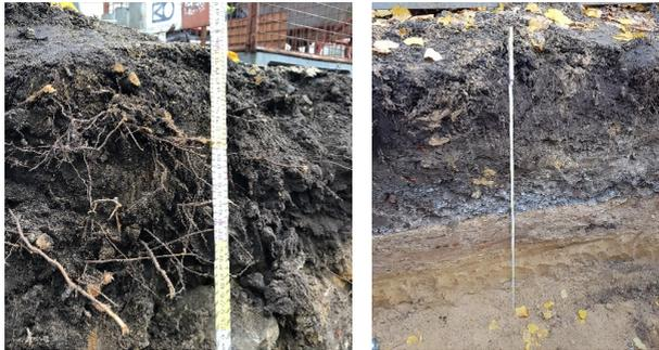
Abbildung 12: Wurzelgeflecht in Vegetationstragschicht (links) und keine sichtbaren Wurzeln in Sandbettung (rechts)
