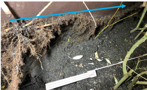
Abbildung 62: Wurzelwachstum oberflächennah auf der kalten Seite von Reihe 1 bis zur Reihe 3 in Versuchskiste E (blauer Pfeil)
