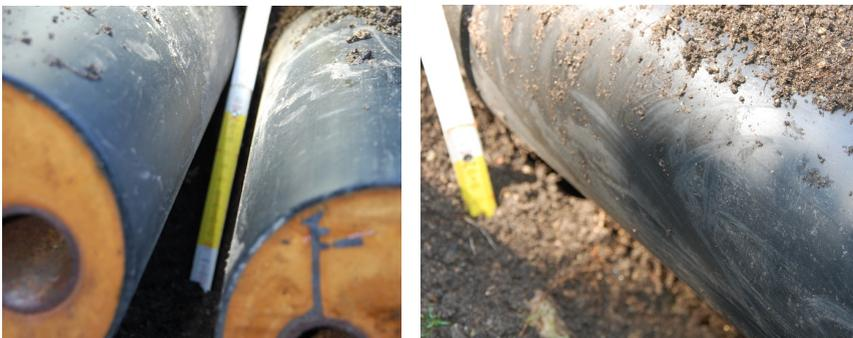
Abbildung 73: Rohrmanteloberflächen aus Versuchskiste A (links) und Versuchskiste C (rechts)
