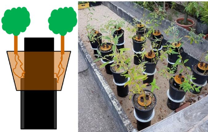
Abbildung 63: Versuchsaufbau zur Wurzelfestigkeit von KMR-Muffenverbindungen
