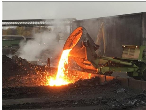
Abb. 5: Abguss der reduzierten EOS im flüssigen Zustand.
