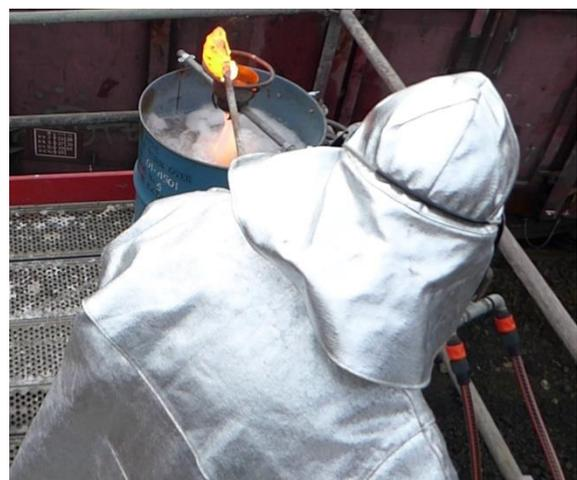
Abb. 7: Bühne am Schlackenplatz mit mobiler Wassergranulation.
