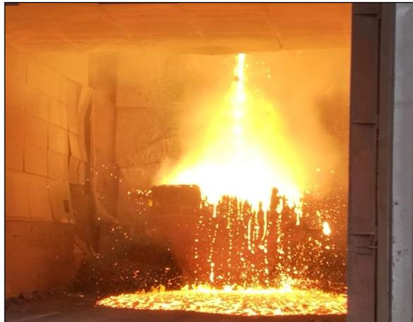
Abb. 3: Reduktionsreaktion während des Abstichs der flüssigen EOS.
