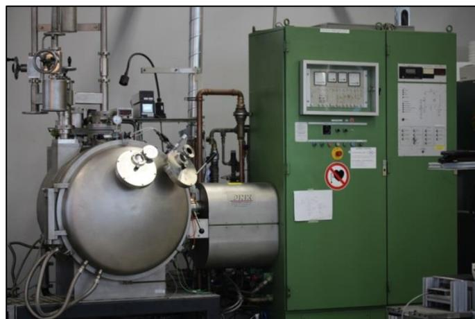
Abb. 9: Vakuuminduktionsofen.
