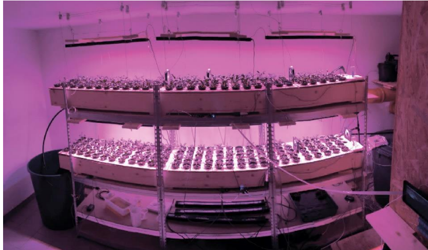
Abb. 2 Spinat wächst in den beiden Pflanzschalen. Die obere Schale wird von einer LED-Zeile, die untere von zwei parallelen LED-Zeilen beleuchtet, sodass Beleuchtung mit verschiedenen Lichtstärken erzielt werden.
