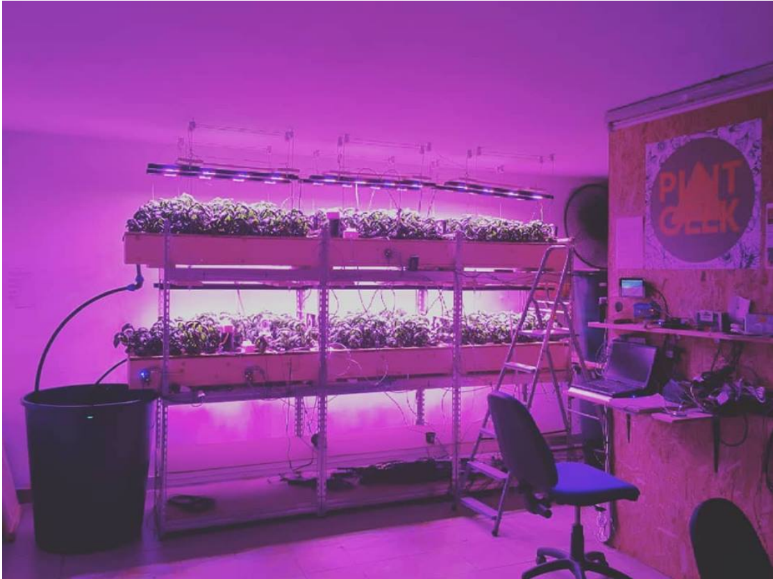
Abbildung 2: Das PlantGeek Labor; auf dem bild sind die basilikumkultivierungsschalen zu sehen und die wichtigsten plattformen, auf denen die daten von sensoren und der schnittstelle auf einem lokalen laptop gesammelt werden
