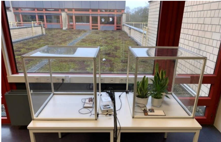
Abb. 38 Versuchsaufbau zur Erfassung des Einflusses von Pflanzen auf die Luftqualität in Innenräumen. Links: Messkammer ohne Pflanzen. Rechts: Messkammer mit Pflanzen
