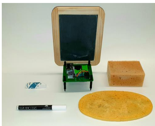
Abb. 32 Links: Versuchsaufbau zur Messung der Feinstaubemission. Rechts: Messwerte beim Beschriften einer Tafel mit unterschiedlichen Kreidesorten und anschließendem Wischen mit einem trockenen und einem feuchten Schwamm.
