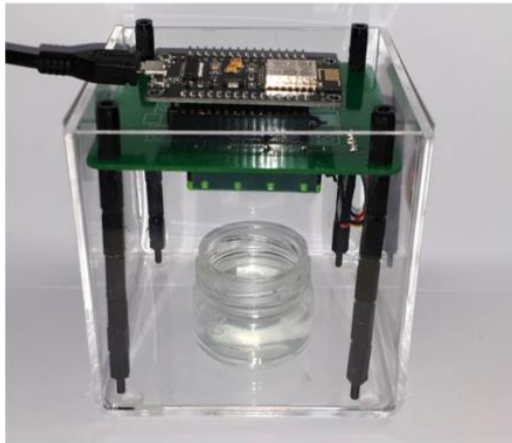
Abb. 26 Links: Versuchsaufbau zur Sensormessung in der Station „Ich rieche was, was du nicht riechst“. Rechts: Typische Messkurven über einen Zeitraum von 60 Sekunden für unterschiedliche Verdünnungen von Ethanol:Wasser. Die Sensormessung ermöglicht die zuverlässige Bestimmung der Reihenfolge. Die Nase ist nicht in der Lage, die niedrigsten drei Konzentrationen überhaupt wahrzunehmen.
