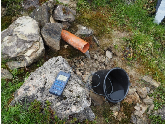
Messung von Schüttung und Leitfähigkeit
