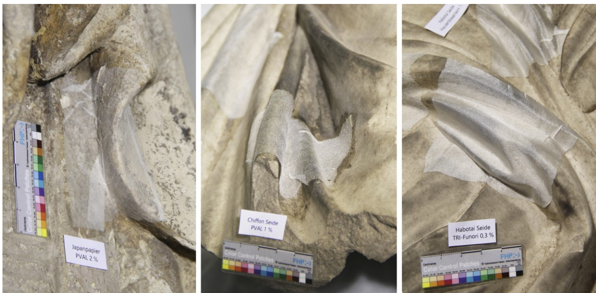
Abbildung 59: Facing-Materialien nach den Applikationsversuchen; Echt Japan-Seidenpapier (li.), Chiffon-Seide (Mitte) und Habotai-Seide (re.)
