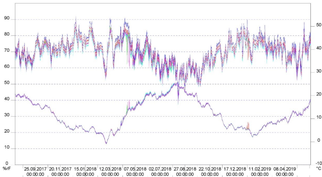
Abbildung 47: Hohe Übereinstimmung der raumklimatischen Messwerte der relativen Luftfeuchte und Lufttemperatur an den Skulpturen
