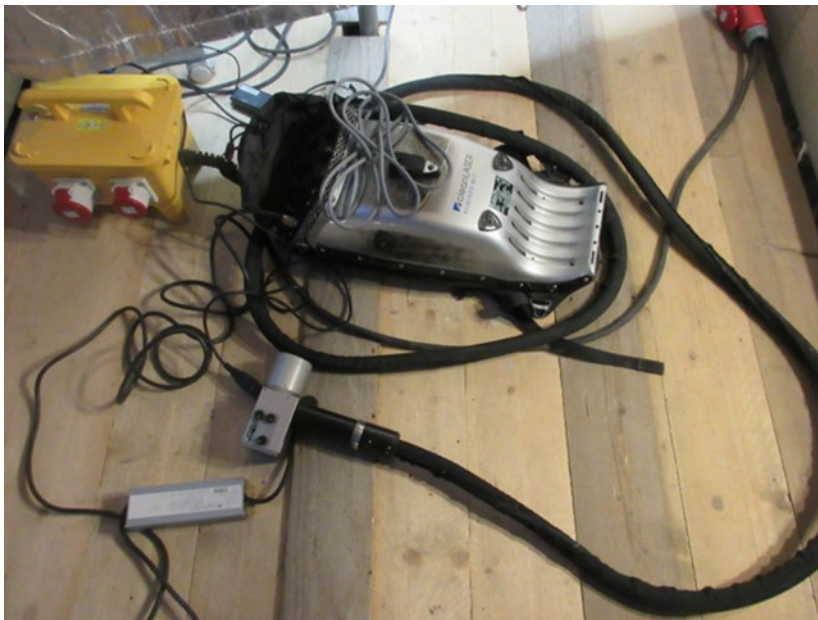
Abbildung 82, Abbildung 83: Schutzkabine und Lasergerät zur Reinigung der Skulpturen.
