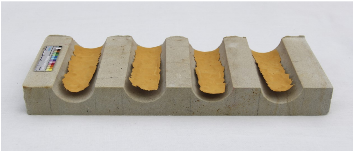
Abbildung 58: Probekörper mit absteigender Malschicht.
