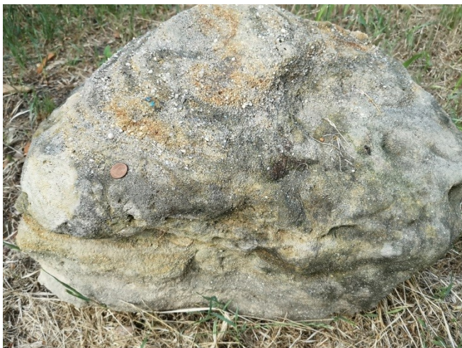
Abbildung 45: Involutussandstein aus den Spiegelsbergen bei Halberstadt mit gröberen und feineren Wechsellagerungen und typischen gut gerundeten groben Komponenten, braunen limonitischen Bereichen und löchrigen Auswitterungen.
