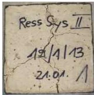
Bild 13: geschädigter Probekörper
