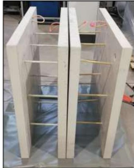
Bild 41: Funktionsmuster Sandwichelemente
