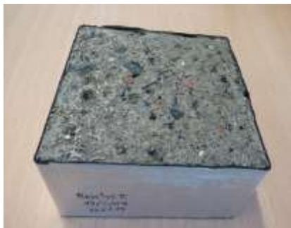
Bild 12: geschädigter Probekörper
