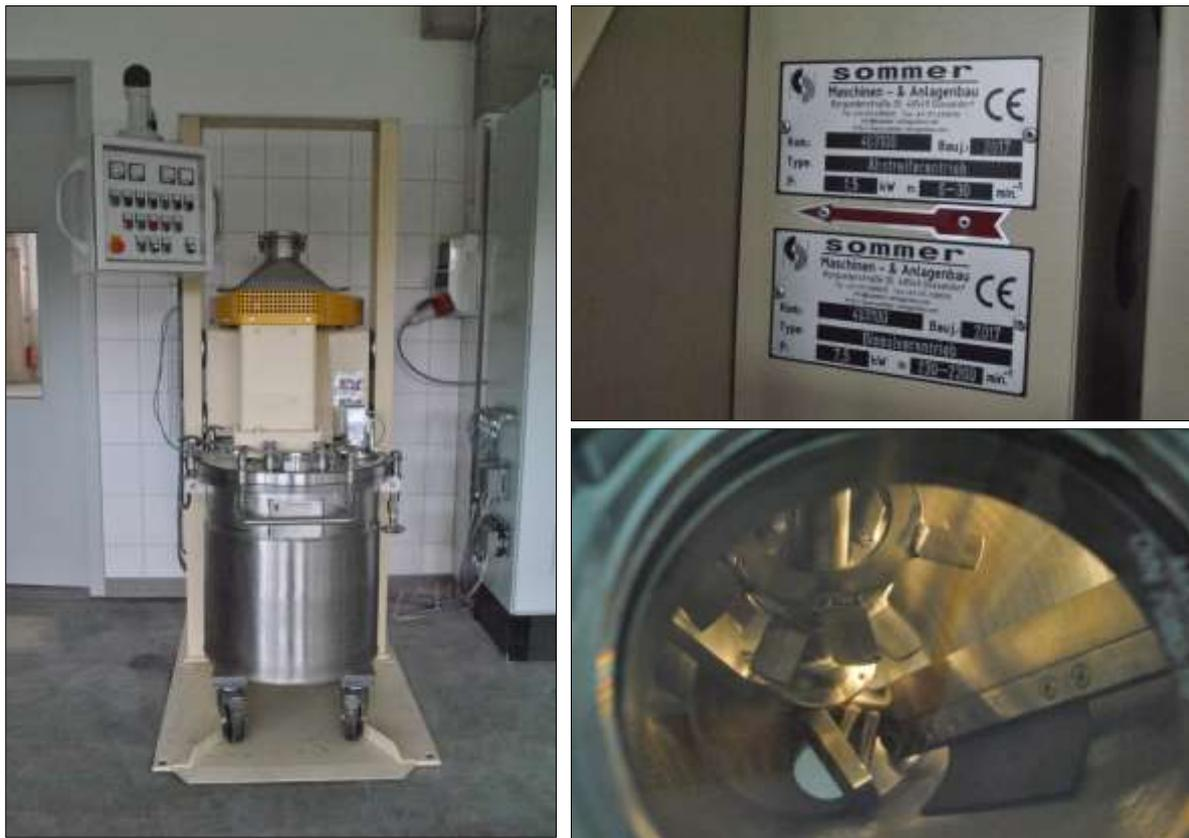
Bild 16: Laborsuspensionsmischer der Fa. Sommer im IAB Weimar
