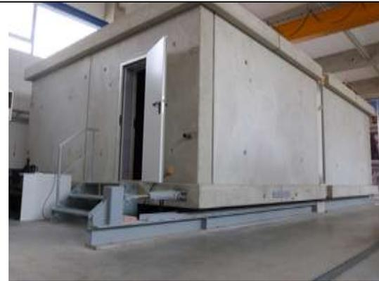
Bild 25: Schallprüfstand am IAB
