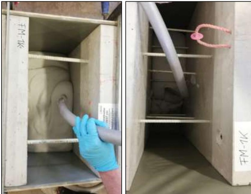
Bild 43: Befüllung der kleinen Musterelemente mit mineralischem Dämmschaum
