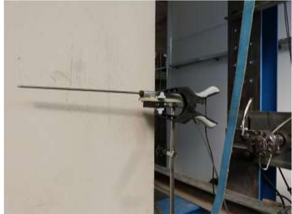
Bild 29: Sensor zur Erfassung der Durchbiegung
