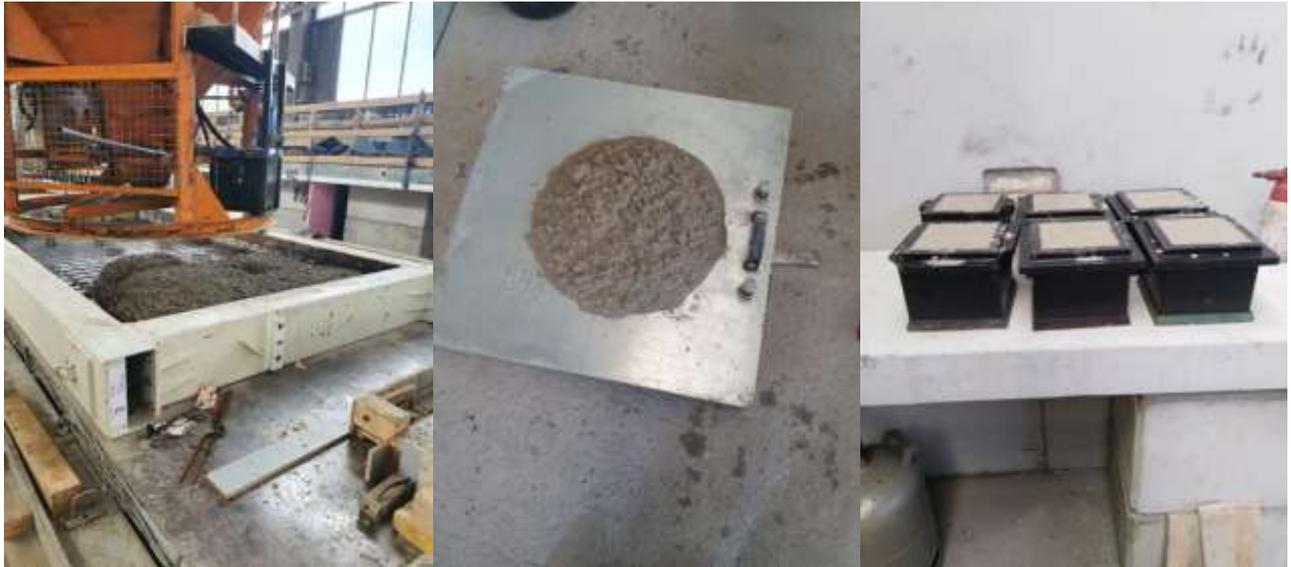
Bild 21: Betonage Komplett-Wand    Bild 22: Prüfung Ausbreitmaß    Bild 23: Probekörper
