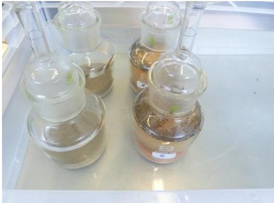
Bild 8: Pycnometerverfahren
