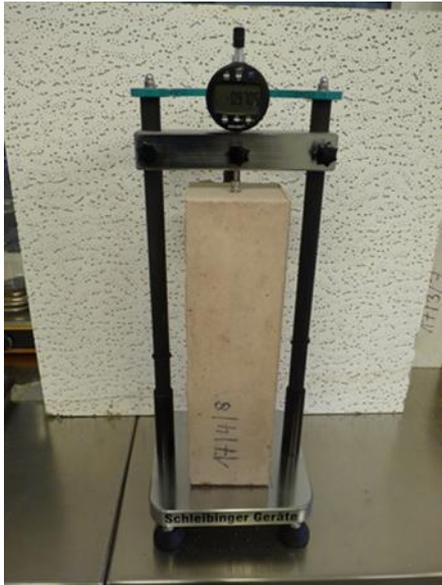
Bild 18: Schwindmessung IAB
