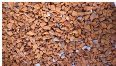
Bild 4: Dachziegel 8/22
