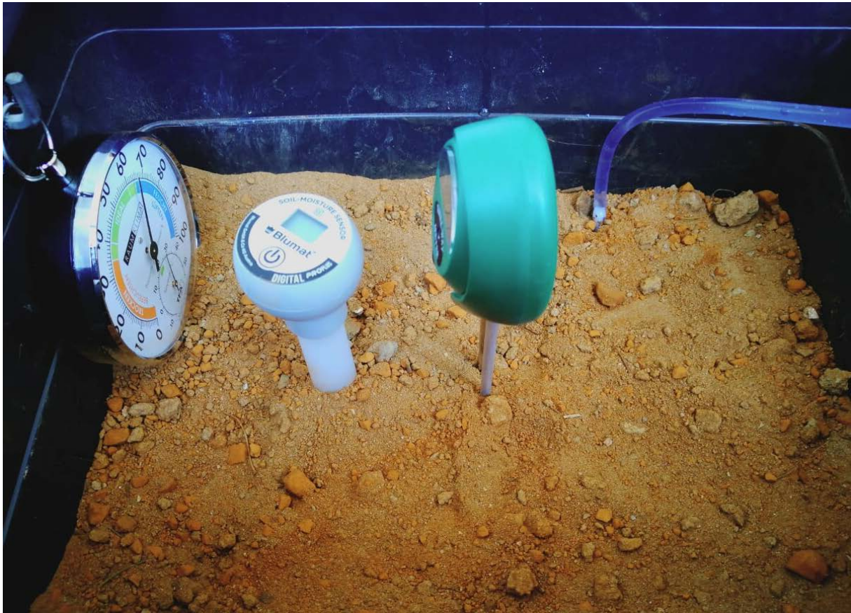
Abbildung 28: Messanordnung im Behälter mit Laterit-haltige Erde (von links nach rechts: Hygrometer, Tensiometer, Bodenfeuchte-Messgerät, Tonkörper-Schlauch)
