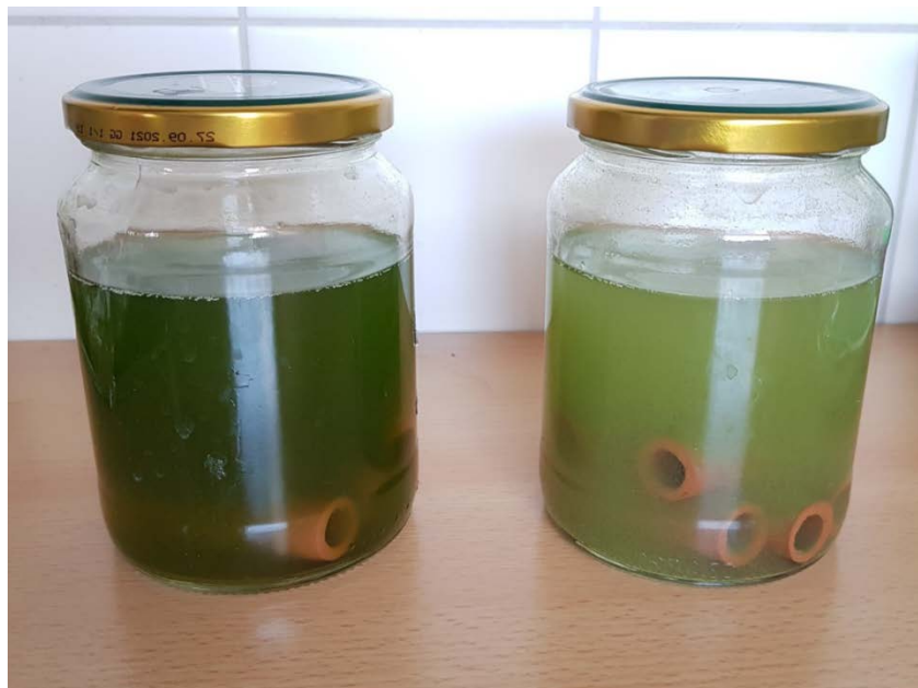
Abbildung 17: Wasser-Algenlösung und Tonkörper (links) ohne und (rechts) mit Phosphatbinder
