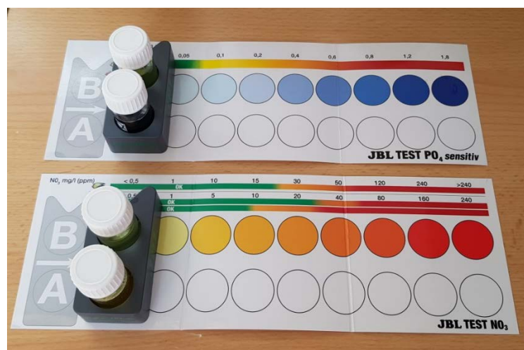
Abbildung 16: Ermittlung des Phosphat- (oben) und Nitratwertes (unten) durch Verwendung von Indikatorfarbstoffen
