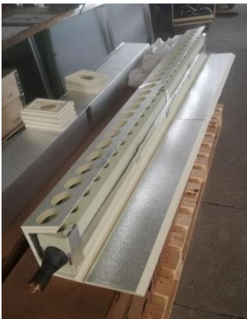
Abb. 11: erste Montage der entworfenen Isolierung
