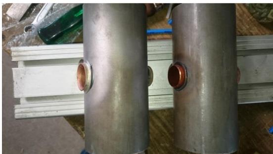
Abb. 16: verschiedene Lötungen aus der Versuchsanlage.
