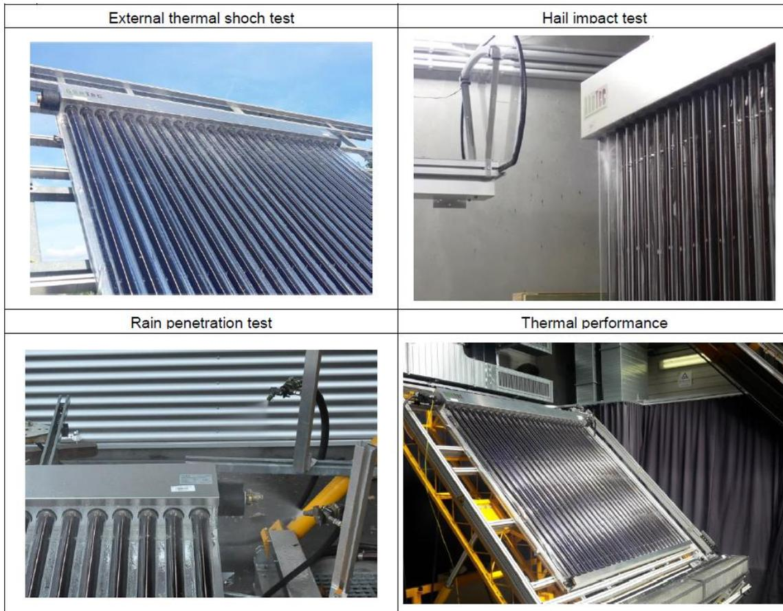
Abb. 15: Vermessung eines MEGA-Kollektorsegments beim TÜV Rheinland
