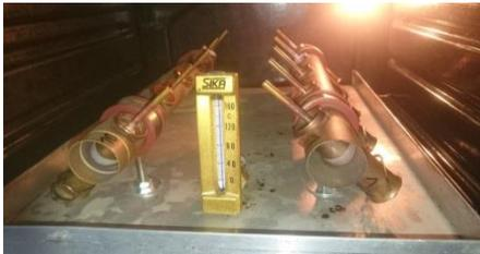
Abb. 10: Versuche zum Auslaufen der Wärmeleitpaste
