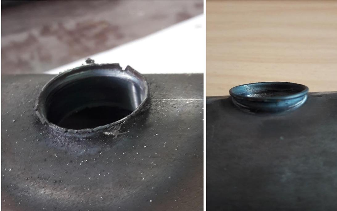
Abb. 17: erste Versuche der flowdrill Bohrung (links) und eine funktionsfähige Bohrung (rechts)
