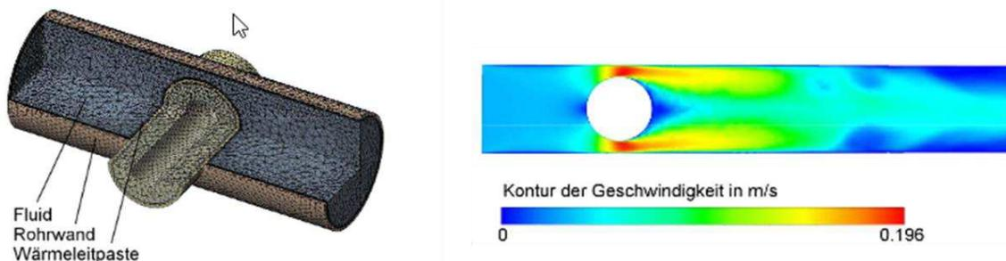
Abb. 2: Strömungen im Sammlerrohr und Verwirbelungen um die Hülse
