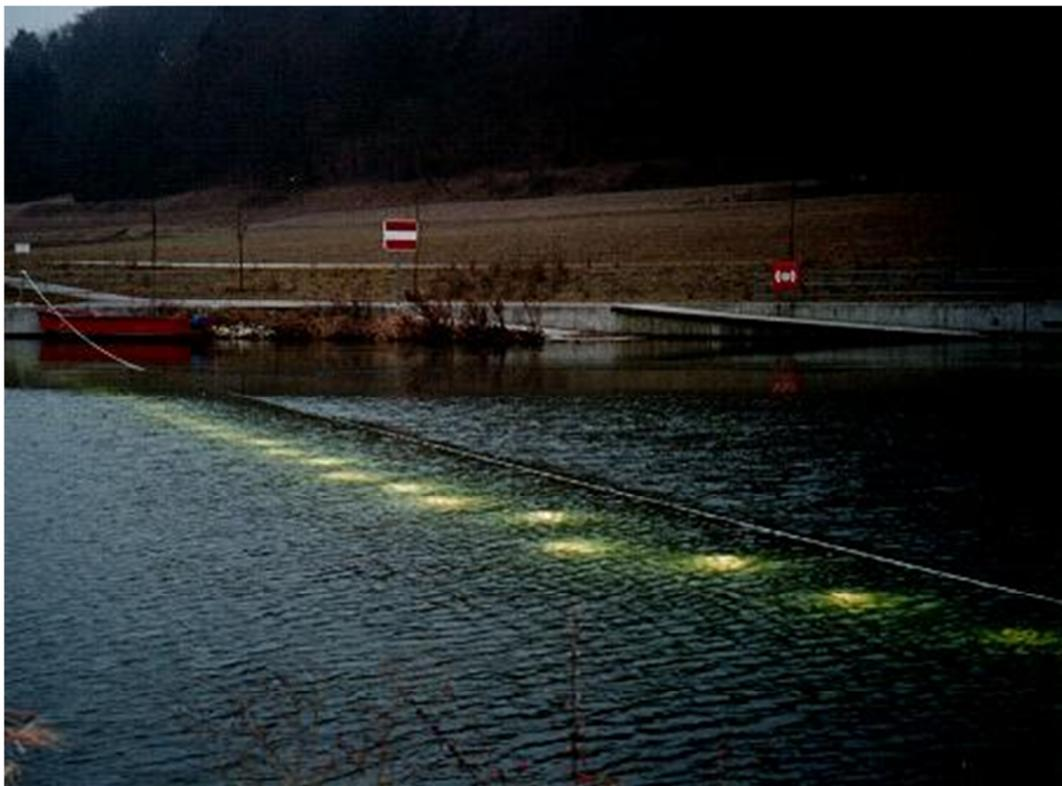
Abb. 39: Tests mit einer Lampenkette zur Abschreckung von Aalen vor dem Einlauf in ein Wasserkraftwerk an der Altmühl (aus: DWA 2005)
