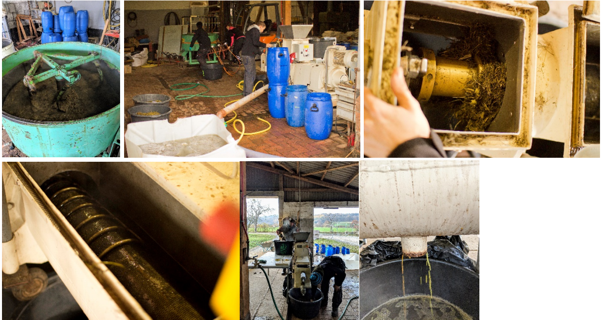
Abbildung 8: Integrierte Festbrennstoff – und Biogasproduktion aus Biomasse (IFBB)
