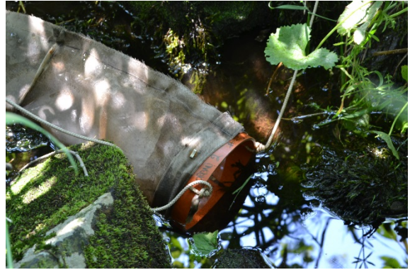
Abbildung 6: Schwimmfähige Samenfalle zur Untersuchung der Hydrochorie
