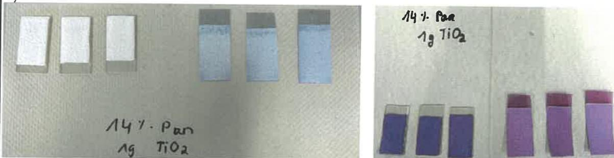
Abb. 3. PAN/ $\text{TiO}_2$ -Folien, aufgebracht auf leitfähigen Gläsern und Graphitfolien, vor (links) und nach dem Färben (rechts).
