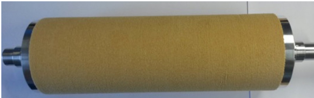
Abbildung 7: Foto einer Vliesstoffwalze mit alternierenden, im Durchmesser unterschiedlichen Ronden desselben Vliesstoffmaterials
