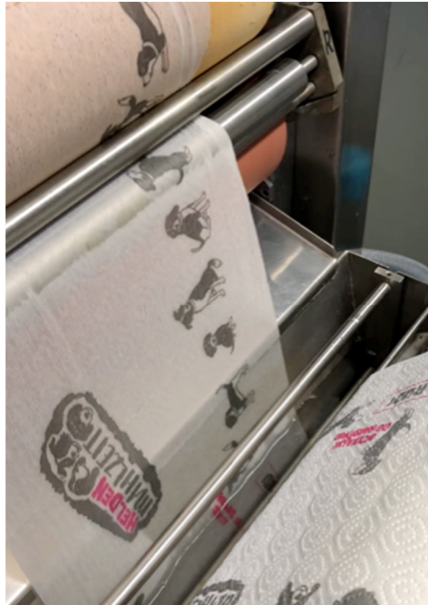
Abbildung 14: Einrichtung zur Benetzung und Entwässerung von Papierbahnen mit Omega-Umwicklung der Vliesstoffwalze (obere Walze)
