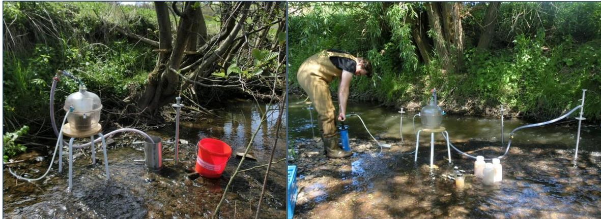
**Abbildung 3:** Sedimententnahme mittels eines Stechzylinders (links) und mit Schlagrohren (rechts). Der Stechzylinder wird ins Sediment gedreht, das grobe Material wird mit einer Schaufel entnommen. Mit der Exsikkatorpumpe werden (Rest-) Wasser samt Feinsedimente abgepumpt. Die Stechzylinder- und die Schlagrohrproben werden aus 10-15 cm Tiefe entnommen.
