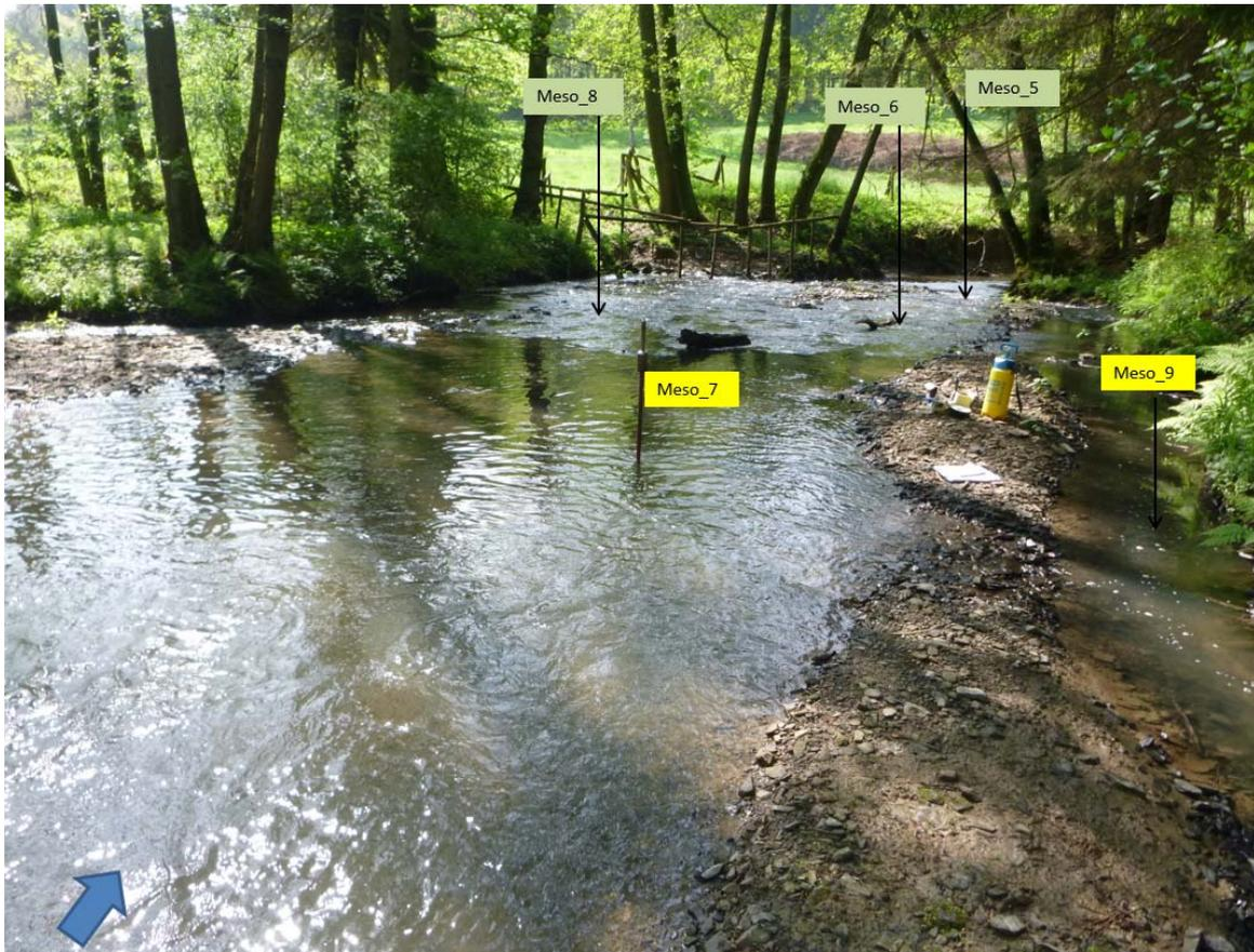
Abbildung 9: Probestelle Naafbach\_3 mit Verortung von 5 der 10 Kolmometer-Teilproben
