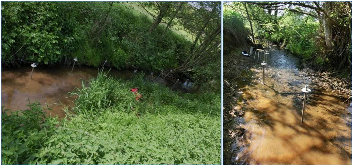
**Abbildung 4:** Anordnung der Schlagrohre am Reichenbach. Links Abschnitt 1, rechts Abschnitt 2.
