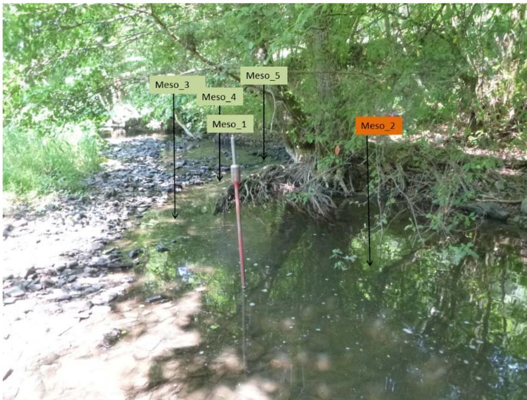
Abbildung 29: Probestelle Elzbach\_3 mit 5 der 10 Kolmometer-Teilproben
