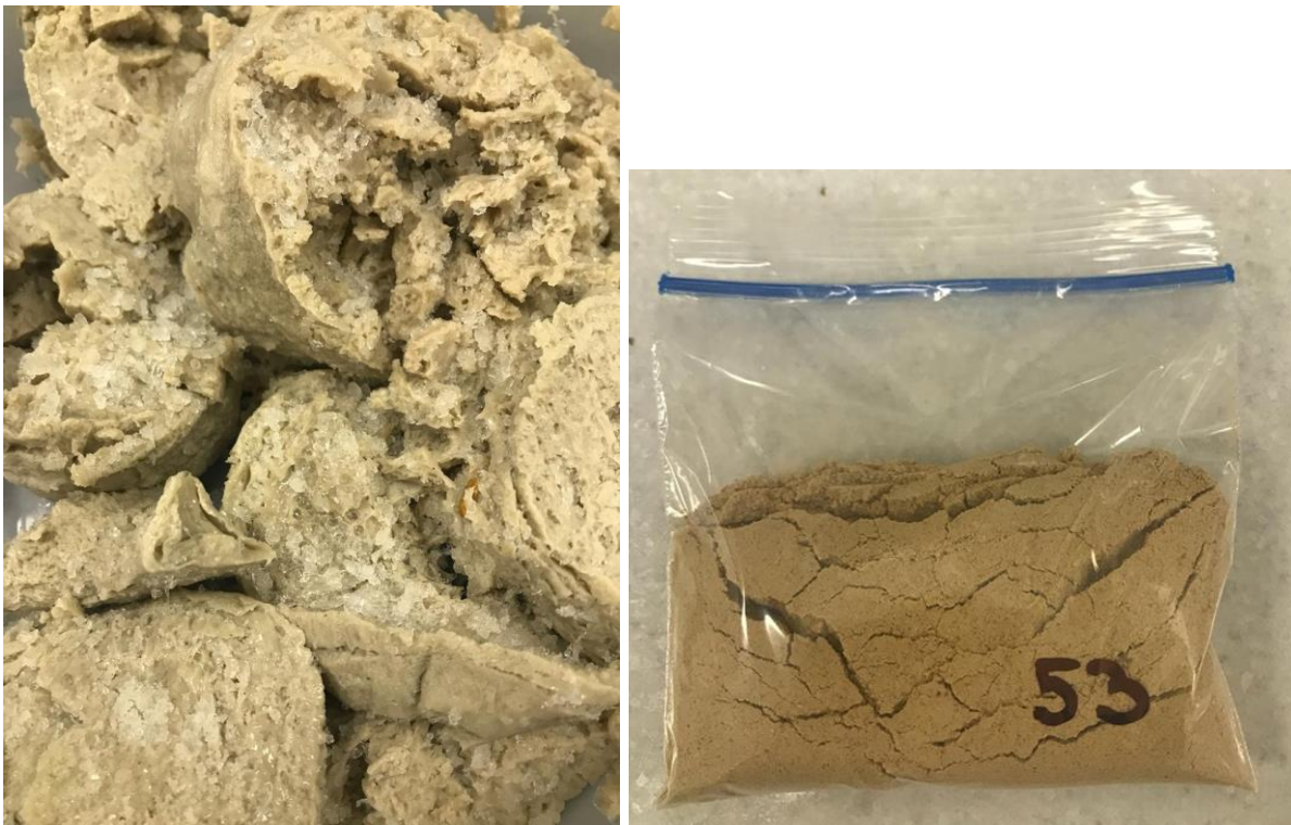
Abbildung 27: Presswasser aus der Fischmehlproduktion (links) und Fischproteinhydrolysat aus Presswasser aus der Fischmehlproduktion (rechts)
