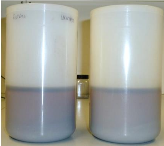
Abbildung 15: Getrennte Phasen nach der thermischen Hydrolyse und Zentrifugation.
