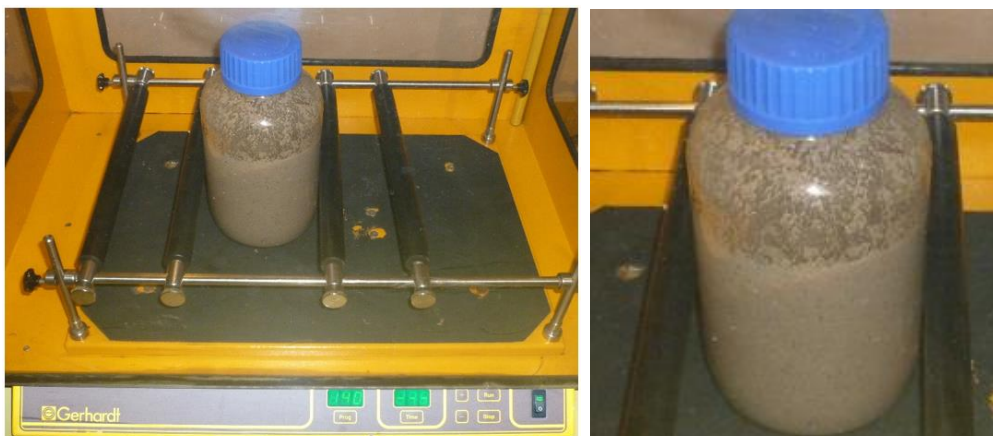
Abbildung 17: Ansatz der enzymatischen Vorbehandlung im temperierten Schüttler.
