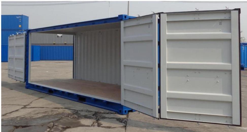
Abbildung 7: Beispielbild eines High-Cube-Open-Door-Container
