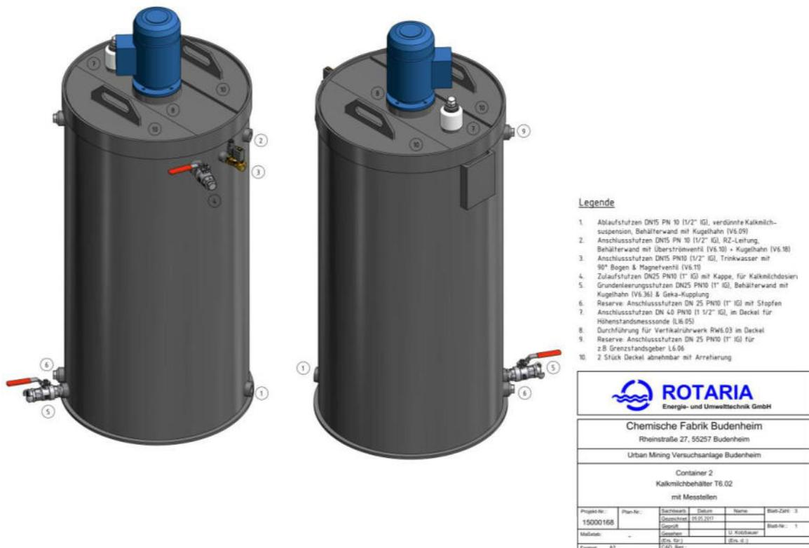
**Abbildung 53: Kalkmilchansetzstation BG 06**
