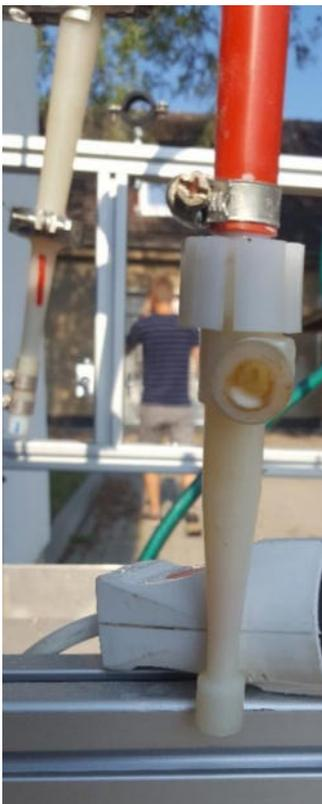
Abbildung 48: Hydrozyklon
