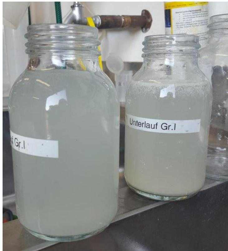
Abbildung 49: Überlauf- und Unterlauf des Hydrozyklons
