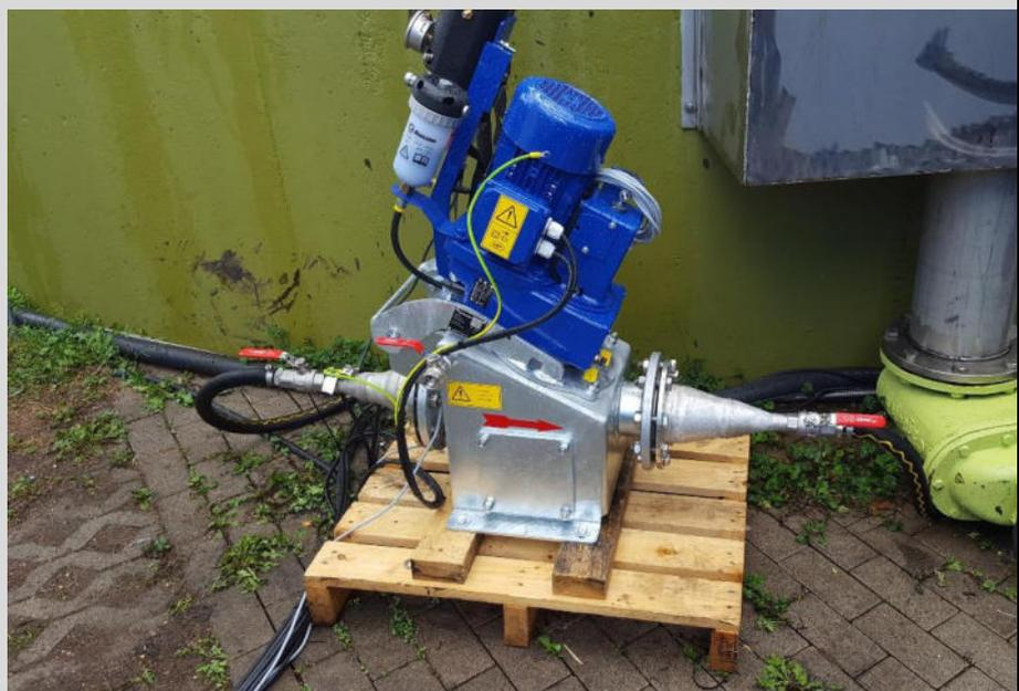
**Abbildung 21:** Feststoff- und Faserzerkleinerer Fabrikat Vogelsang; Typ Rota-cut Mazerator
