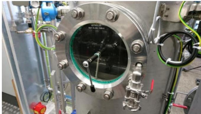
**Abbildung 37: Schauglas mit Spülwasseranschluss und Wischer**
