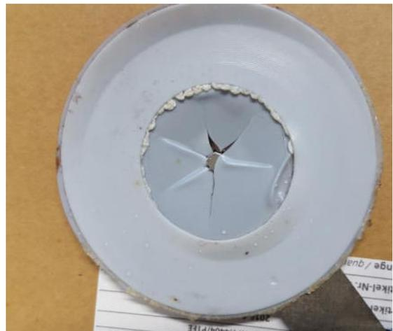
Abbildung 6: durch Überdruck ausgelöste Berstscheibe
