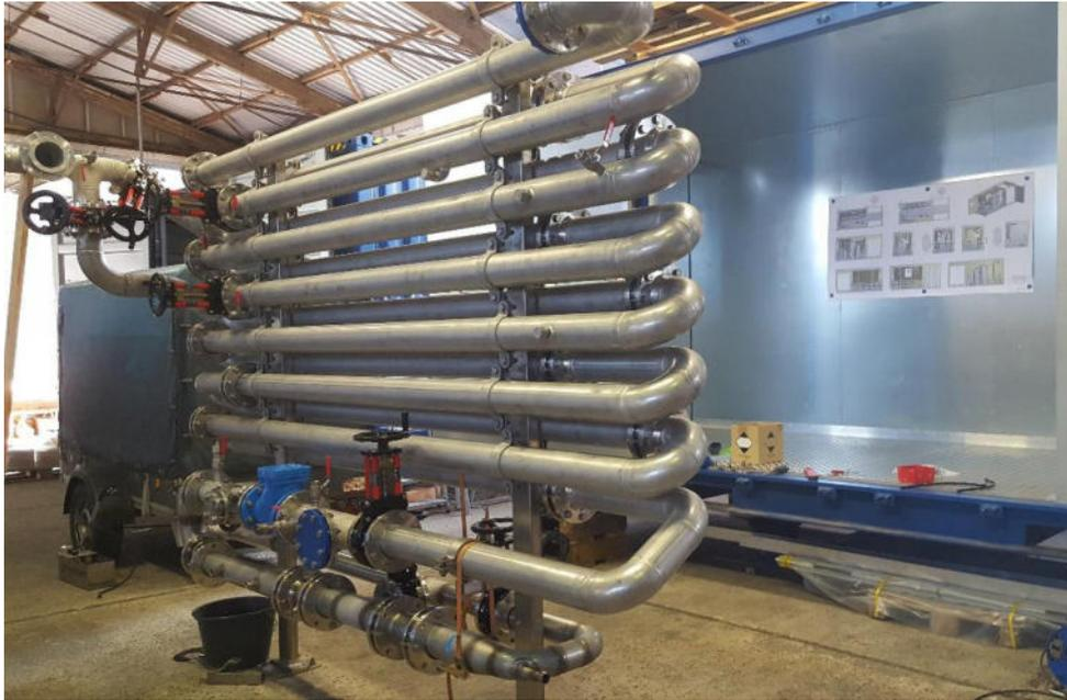
**Abbildung 26: fertigmontierter Rohrschlaufenreaktor vor dem Container**
