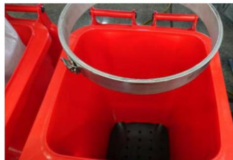
Abbildung 60: Tonne mit Ringhalter und Ablauf durch den Boden
