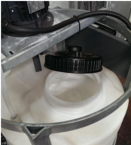
Abbildung 22: Fällung der Regeneratlösung (Probe AQ1) mit \text{CaCl}_2 in Technikumsanlage
