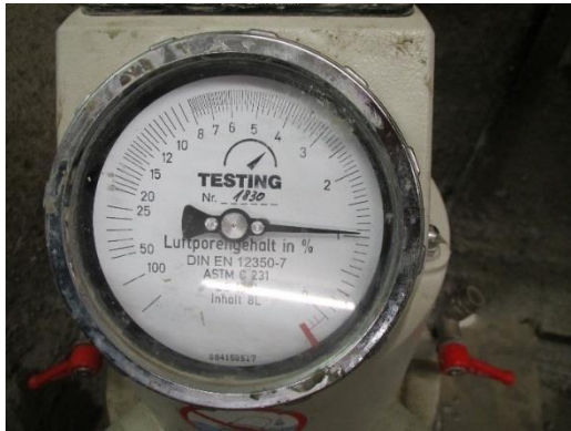
Abbildung 19: Prüfung des Betons vor Auslieferung im Werk [Jacob]
