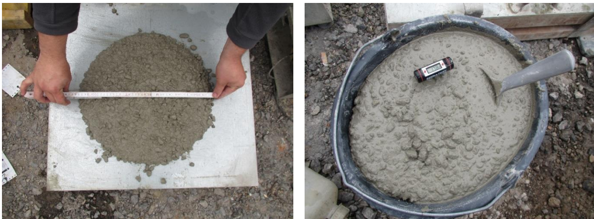
Abbildung 23: Überprüfung des Ausbreitmaßes und Messung der Temperatur auf der Baustelle [Jacob]
