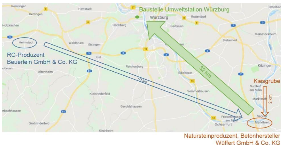
Abbildung 34: Vereinfachte Darstellung der Transportdistanzen der Gesteinskörnungen und für den Beton
