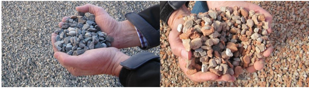
Abbildung 9: RC-GK Typ 1 Betonsplitt, Typ 2 Bauwerksplitt [Mettke].
