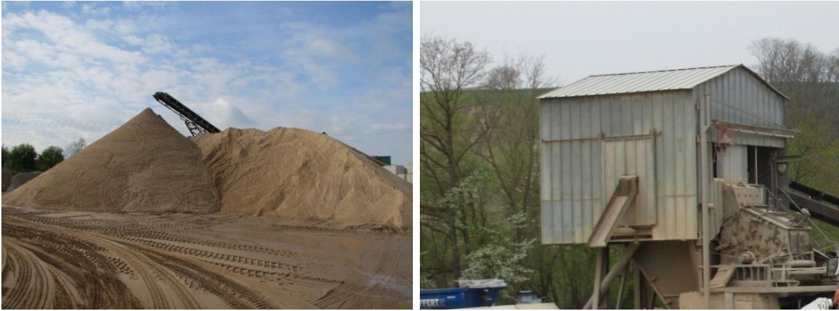
Abbildung 30: Haldenlagerung des Sandes und Prallmühle zur Aufbereitung des Kieses
