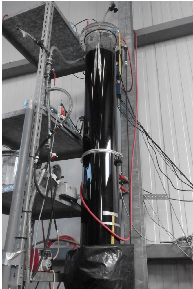
Bild 12: Versuchsaufbau zu Wasserstoffeintrag mit Faulschlamm
