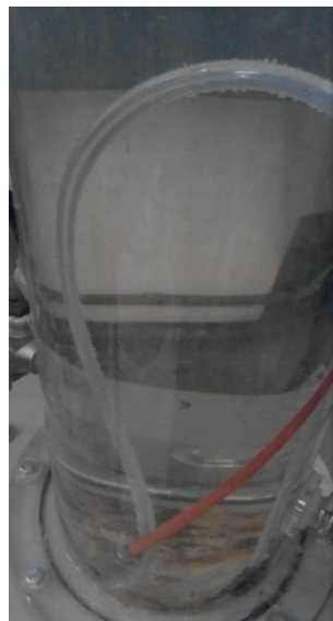
Bild 10: Eintragstest mit handelsüblichen Silikonschlauch
