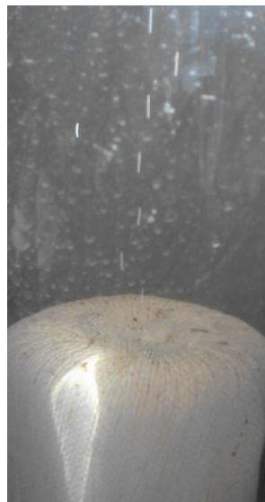
Bild 8: Eintragstest mit AQUADYN UA-420BT Eintrags Element
