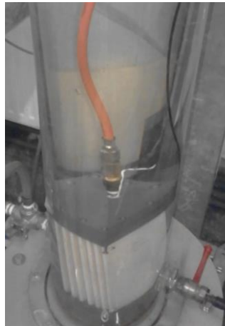
Bild 9: Eintragstest mit Keramikmembran
