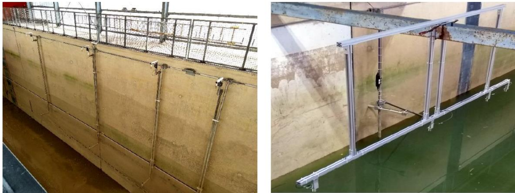
Abbildung 26: Gruppe von vier kapazitiven Wellenpegeln am Rand des GWK (links); Vier Ultraschallsensoren an Aluminiumprofilen vor dem Versuchsaufbau (rechts).
