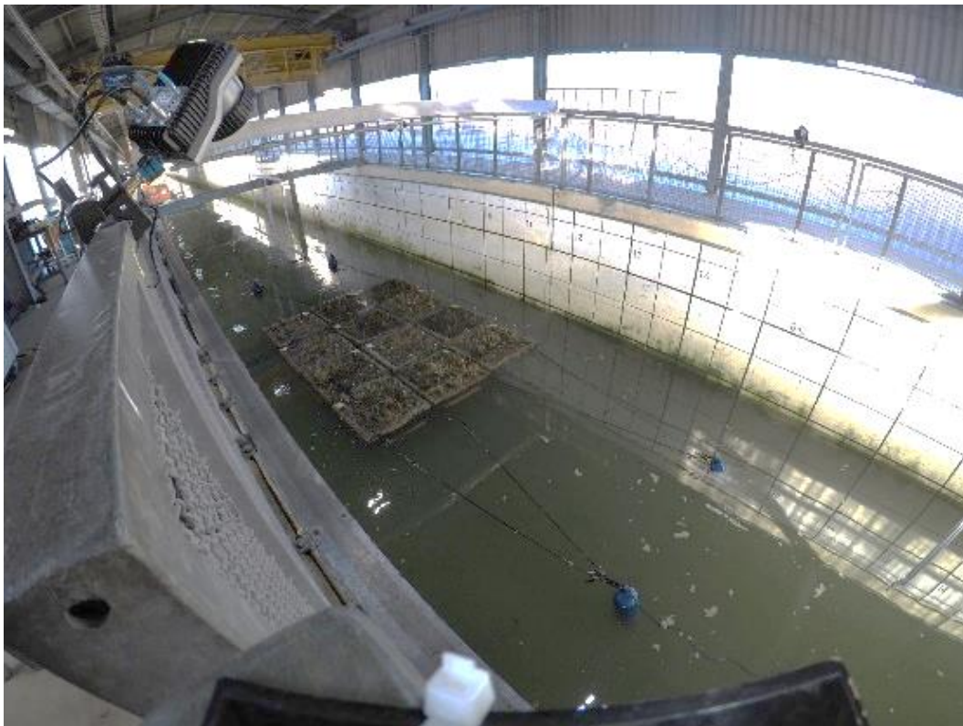
Abbildung 28: Versuchsaufbau in einer perspektivischen Ansicht mit Teil des Motion-Tracking Kamerasystem oben-links im Bild und blauen Fenderbojen sichtbar im Wasser.
