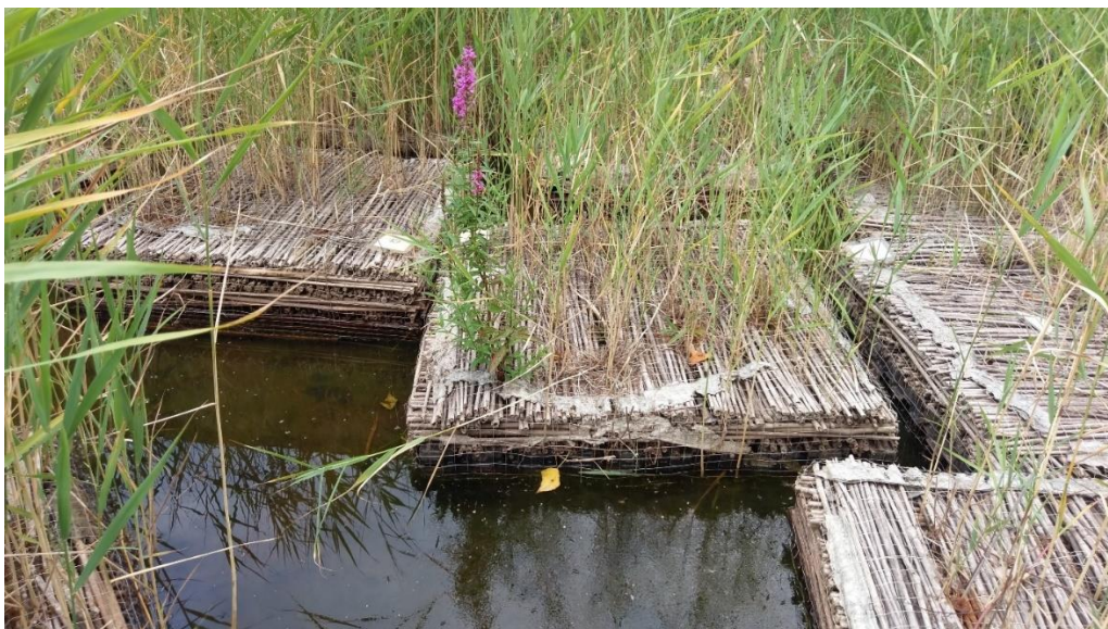
Abbildung 46: Gabionen nach der dritten Vegetationsphase und nach den Tests im Mittellandkanal und Großen Wellenkanal im September 2019
