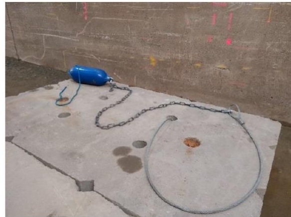
Abbildung 24: Reiterbojen die mit flexiblen Expanderseilen (gelb) mit der „schwimmenden Inseln“ verbunden sind sowie Halteseile (orange) (links); Ansicht eines Schwergewichtfundamentes mit Ankerseil aus Stahl und Kettengliedern bis zur Reiterboje (rechts).
