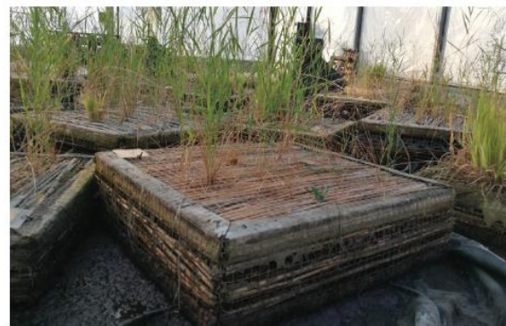
Abbildung 7: Funktions- und Wirkungsschema „Lebender Inseln“ (Günther, 2014) (links) sowie be­pflanzte Gabionenkörpers nach circa einem halben Jahr Wachstum (rechts).
