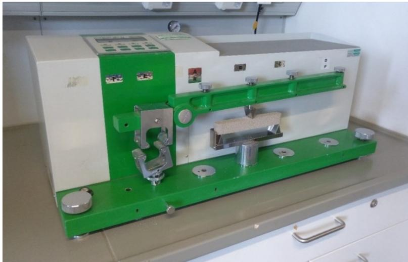
Abbildung 2 - Biegezugprüfgerät der Firma Morek Multiserv
