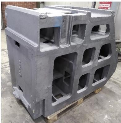
Abbildung 24 - gestrahltes Gussteil
