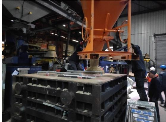
Abbildung 23 - Herstellung des Oberkastens
