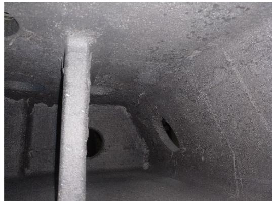
Abbildung 25 - Gussoberfläche in den Taschen des Gussteils
