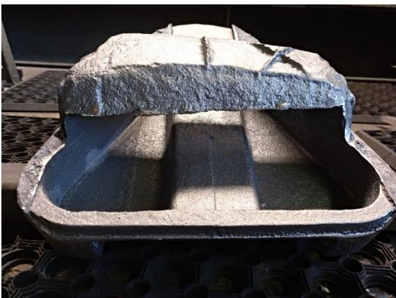
Abbildung 35 - Kern zerfiel trotz Hinterschneidung
