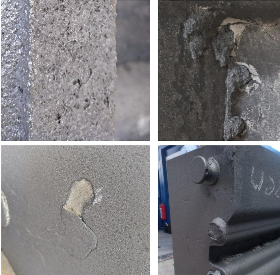
Abbildung 21 - Gussfehler - Industrieabguss (o.l.: Glanzkohlenstoffeinschlüsse / o.r.: Penetration / u.l.: Schlichteschülpfen / u.r.: Penetration am Anschnitt)
