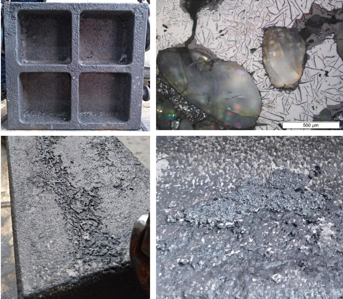
Abbildung 20 - Gussfehler - Technikumsabguss (o.l.: Probekörper / o.r.: Schliffbild Penetration / u.l.: Glanzkohlenstoffeinschlüsse / u.r.: Penetration)
