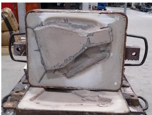
Abbildung 31 - Gussteil nach Abguss mit intaktem Kern
