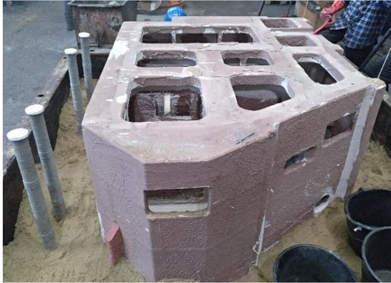
Abbildung 22 - Schaumstoffmodell des Gussteils
