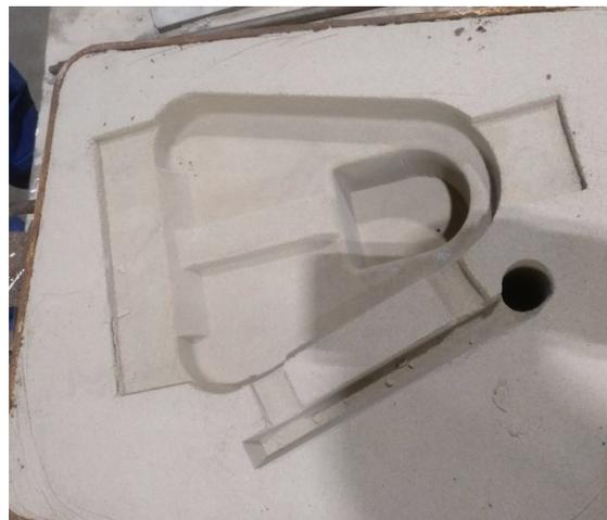
Abbildung 30 - Zementform mit Dauermodell
