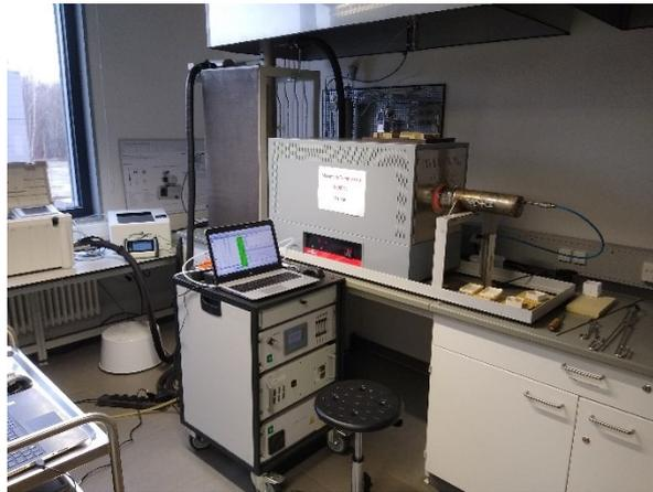
Abbildung 37 - Pyrolyseofen mit angeschlossener FTIR-Messeinheit
