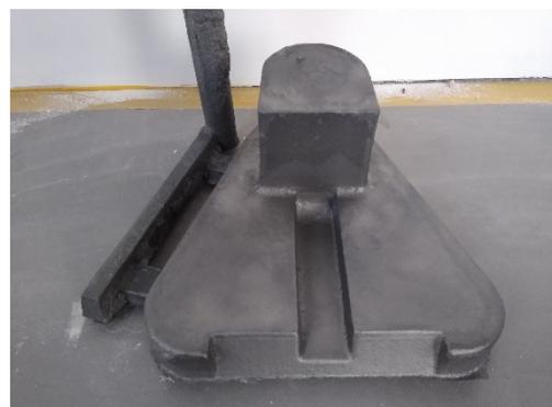
Abbildung 32 - Gusseisen Ständerfuß in Zementformstoff gegossen
