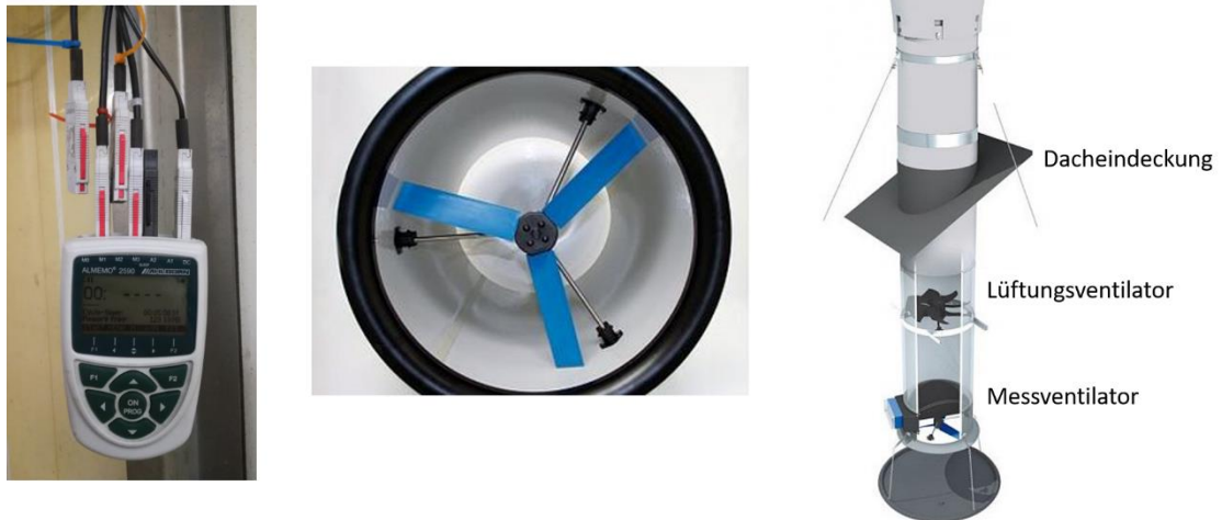
Abbildung 8. Links: Datenlogger der Firma Ahlborn mit Drehzahlmesssteckern (©Lengling). Mitte: Messventilator der Firma Reventa (©Reventa GmbH). Rechts: Schematische Darstellung eines Abluftkamins der Stallgebäude (modifiziert nach R. Brooks Stallklimaanlagen GmbH).
