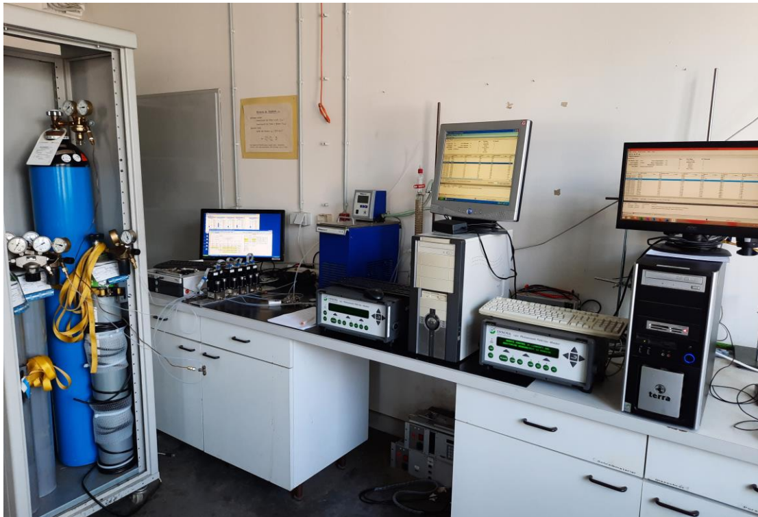
Abbildung 9: Überprüfung der Messgenauigkeit der Gasanalysegeräte an der hauseigenen Gasmischstation des Instituts für Landtechnik (©Lengling).
