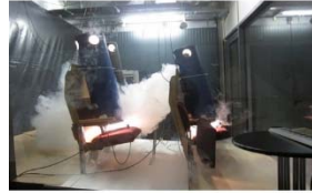
Verbesserung Lüftungsströmung über Stuhllehnen Zuschauerraum
