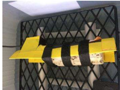
Bild 46: Blick in eine Lagerbox mit TDR-Sonde: Probe über einer gesättigten NaCl-Lösung (75 % r. F.)
