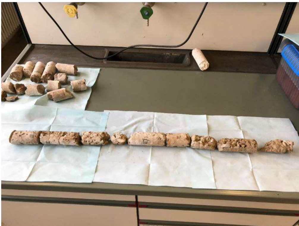
Bild 78: Bohrkerh III - gesamt
