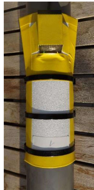
Bild 38: Fixierung der Elektroden um einen Zylinder
