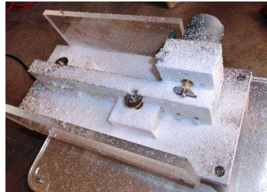
Bild 31: Fräse zum Schlitzten und Nuten der dünnen Rohrsonde
