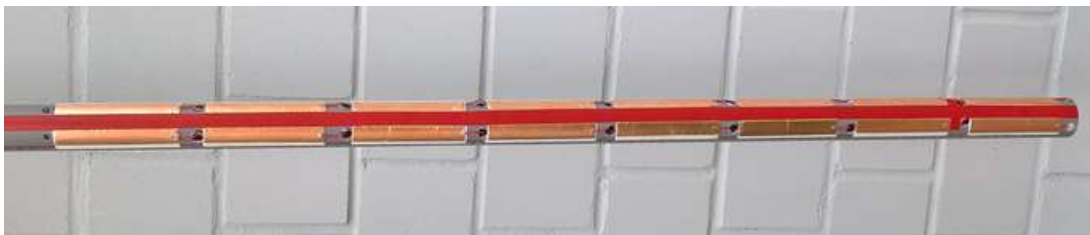
Bild 13: Segmentierte Sonde mit 8 Elektrodengruppen
