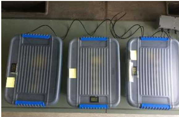
Bild 45: Versuchsaufbau im Labor (Lagerung von Proben in Boxen mit unterschiedlichen relativen Feuchten bei 75, 93 und 99 % r. F.)
