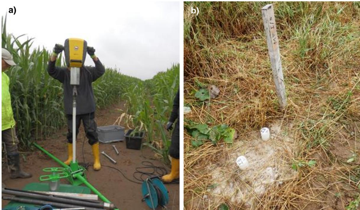
**Abbildung 12:** a) Rammsondierung zur Einrichtung einer Grundwasserentnahmestelle (MP) und b) fertiggestellte Grundwasserentnahmestellen mit 2 m und 3 m unter Geländeoberfläche (Fotos: Astrid Seemann)
