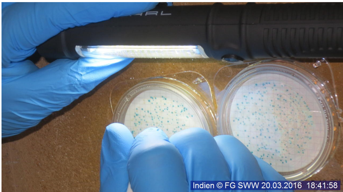
Bild 8: Probenuntersuchung abends – Auszählen der Hygieneproben
