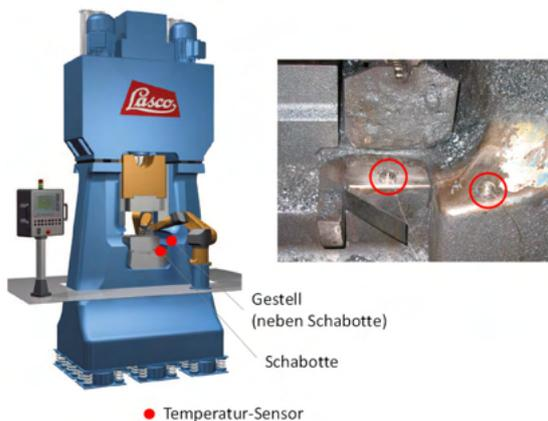
**Bild 26:** Position der Temperatur-Sensoren
