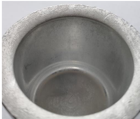
Abbildung 13: Umgeformter und gereinigter Bremskolben ohne Riefen im Napfinneren
