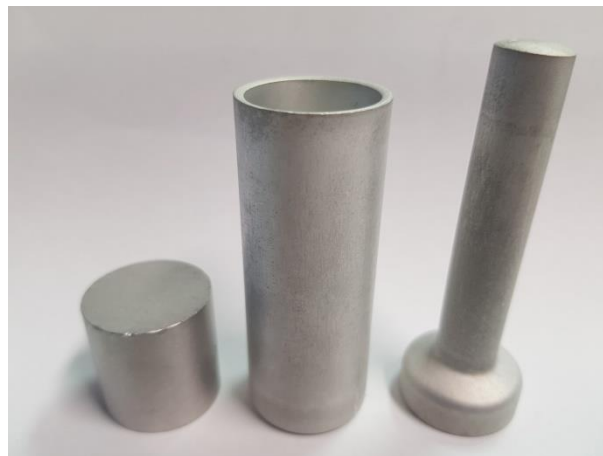
Abbildung 10: Butze (links), mit Umformgrad \varphi = 1,4 naprückwärtsfließgepresstes (Mitte) und vollwärtsfließgepresstes Teil aus Testphase 1
