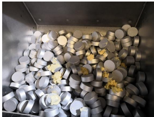
Abbildung 16: Trommel mit Alubutzen und pastösem Schmierstoff ZWEZ-Lube AX
