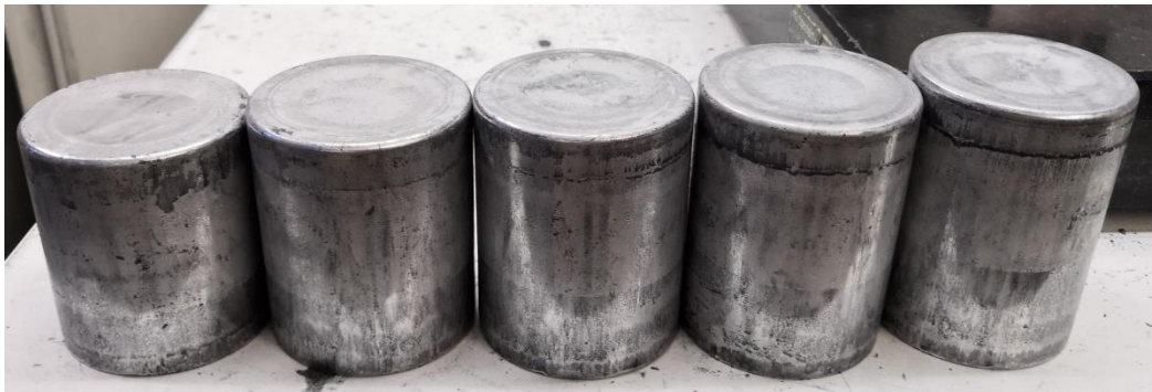
Abbildung 7: Stufenweise Erhöhung der Zustellung zur Fertigung von Bremskolben mit höherem Umformgrad
