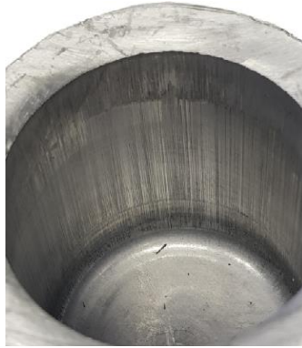
Abbildung 14: Umgeformter Bremskolben mit deutlichen Riefen im Napfinneren
