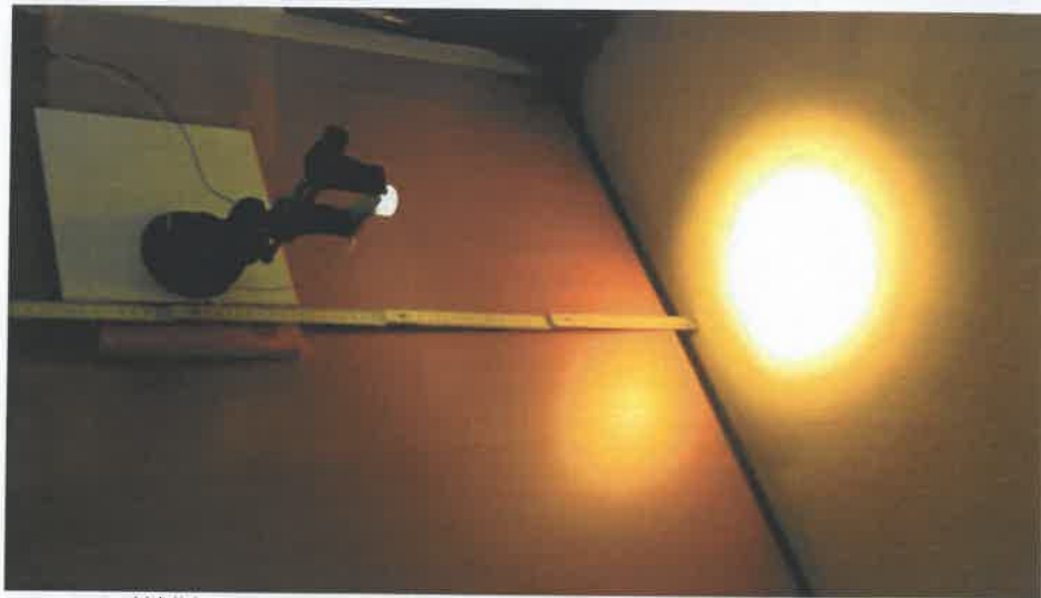
Abbildung 23: erster Test zur Vermessung des Lichtfleckdurchmessers
