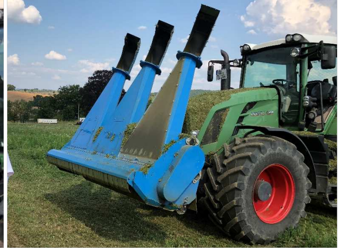
Frontmulcher mit Sichtfenster zur Gutstromuntersuchung
