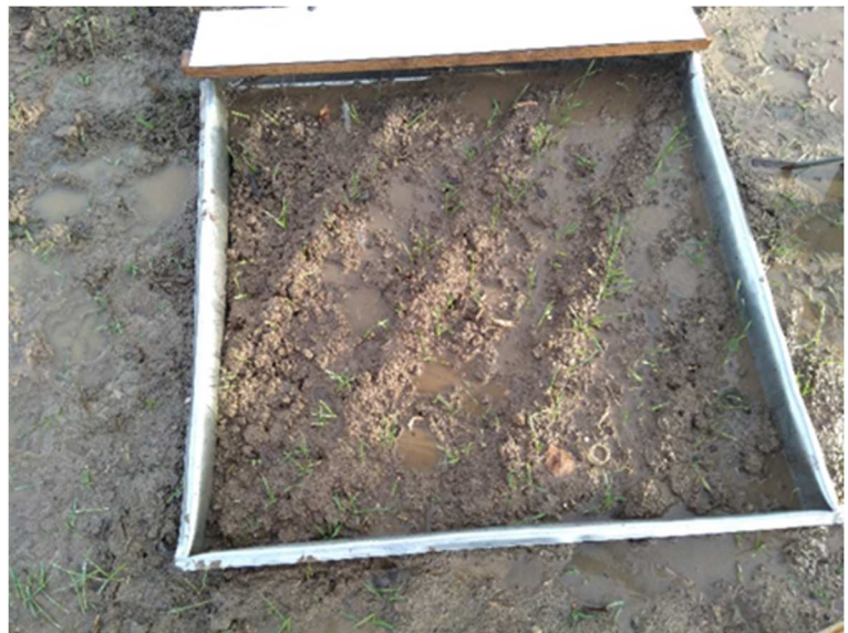
Abbildung 16 Beregnete Testfläche von einem Quadratmeter; Ablauf des Wassers am oberen Bildrand
