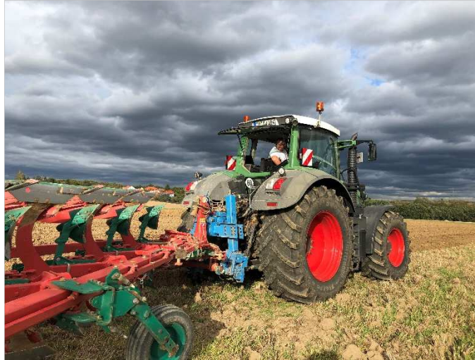
Kraftmessdreieck im Heckanbau zwischen Zugmaschine und Pflug
