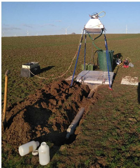
Abbildung 15 Aufbau und Positionierung des Niederschlagssimulators
