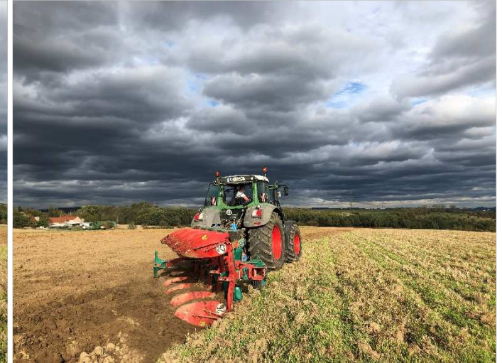
Kraftmessdreieck im Heckanbau zwischen Zugmaschine und Pflug
