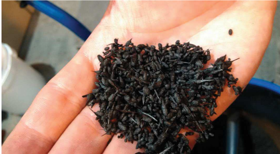
Abbildung 7: Fiberballs mit längeren CF-Anteilen
