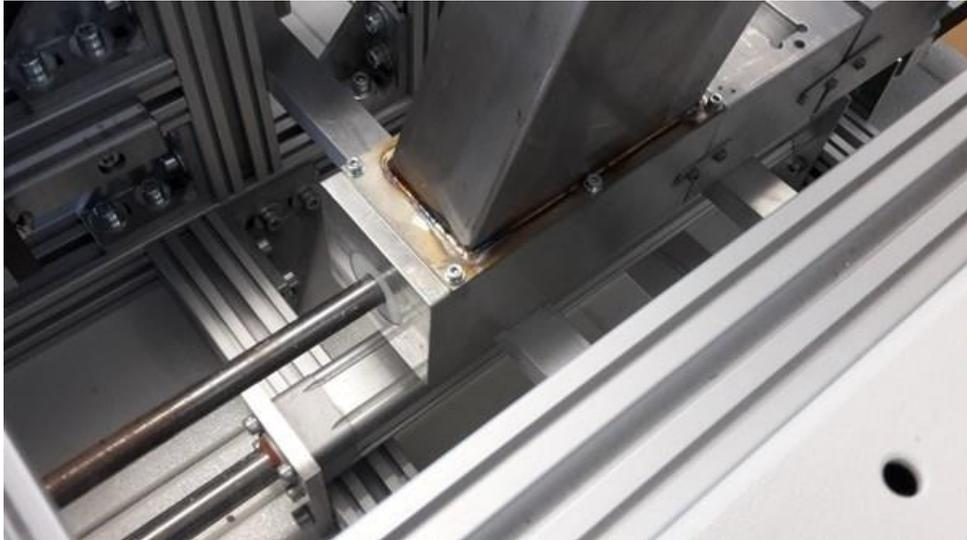
*Abb. 17: Teflonrohr mit Stößel, montiert am Einfüllstutzen*
