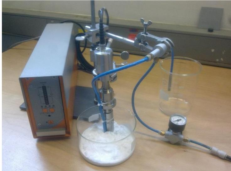
*Abb. 14: Vorrichtung zur Erprobung der Pulverförderung mit US-Anregung*
