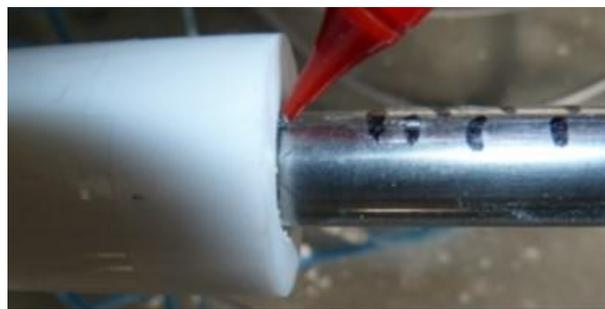
*Abb. 11: Detailaufnahme Flussmittelbehälter (links) mit Pulvervorschub*
