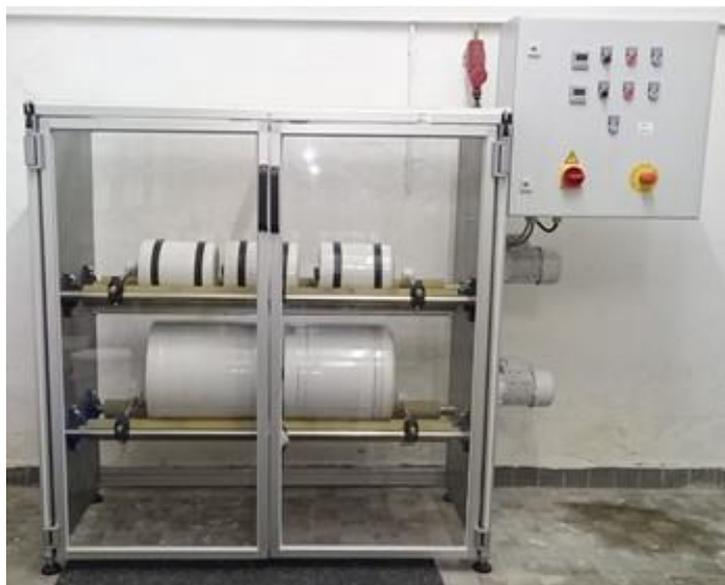
*Abb. 5: Kugelmühle zur Vorbereitung der Pulvermischung*
