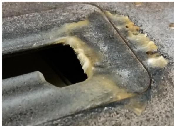
*Abb. 38: Ablagerung von Flussmittelpulver auf der Lötmaske nach mehreren Beschichtungsabläufen*
