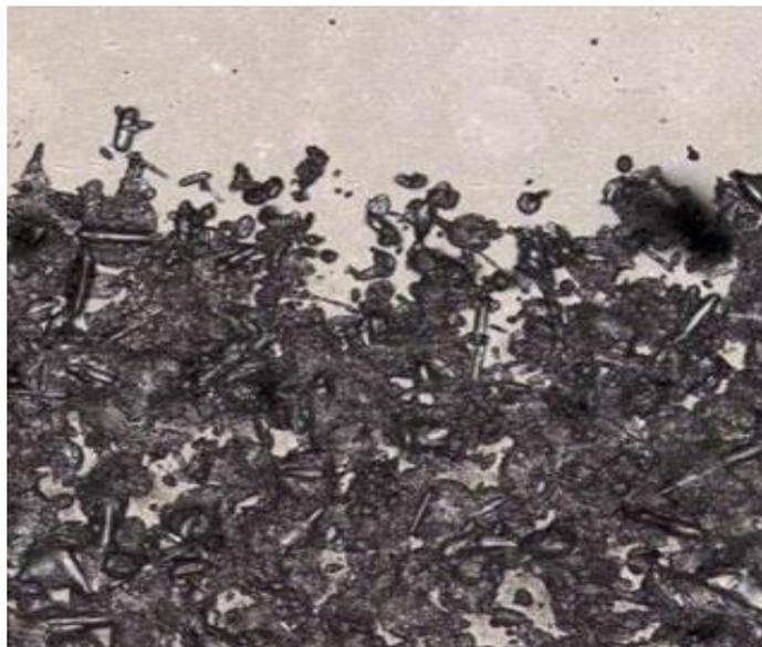
*Abb. 35: Erscheinungsbild des Flussmittelpulvers nach der Beschichtung*
