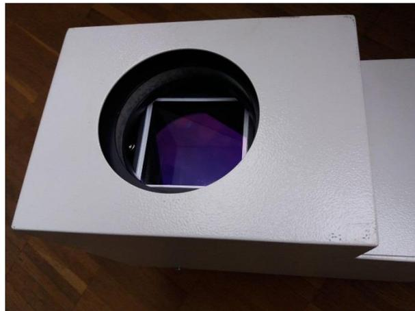
*Abb. 25: Kameramodul für die Bewertung der Pulverbelegung*
