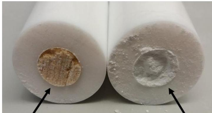
Abb. 39: Flussmittelpulver im Teflonrohr– links: ES-100 S-P; rechts: Adipinsäure
