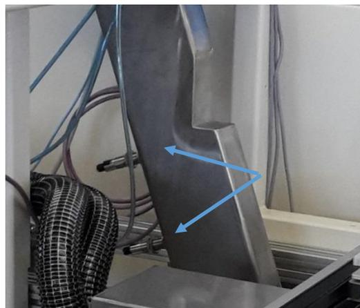
Abb. 16: Detailaufnahme aus Abb. 15 – Füllstandssensoren am Einfüllstutzen
