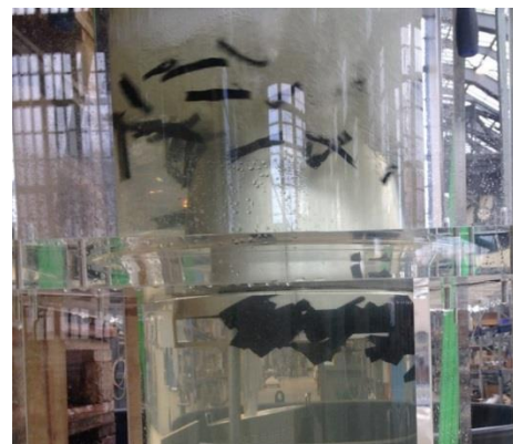
Abbildung 2-9: Ergebnisse der SESSIL®-Vorfüllungsversuche des Tauchbogens "TBr_L_Platte0" im Vergleich zu TBorg bei 4 l/s (5 Min.) (links); SESSIL®-Stücke werden vor Einlauf-Fenstern bei TBr_L-Platte0 gedrückt (rechts)
