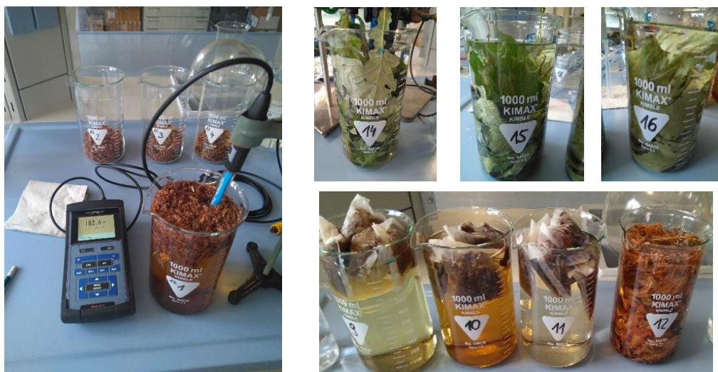
Abbildung 3-18: Versuchsaufbau Laborversuche zum Hydrolysepotential verschiedener Pflanzenbestandteile
