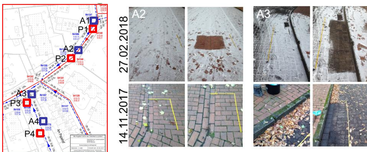
Abbildung 3-5: Lage der beprobten Flächen (A1-A4) im Vergleich zu den beprobten Straßenabläufen (P1-P4) (links); Vorgehensweise bei der Kehrlichtsammlung für die Flächen A2 und A3 für den 27.02.2018 und 14.11.2017 jeweils vorher/nachher (rechts)
