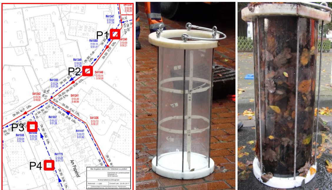
Abbildung 3-2: Lage der ausgewählten Straßenabläufe (P1, P2, P3, P4) im Kanalübersichtsplan (links), Einsatz aus Acrylglas vor dem Einbau (Mitte), Einsatz aus Acrylglas mit Herbstlaub (rechts)
