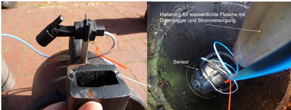
Abbildung 2-13: Anordnung des Schwimmschalters auf dem Tauchbogen (links) und im Straßenablauf (rechts)
