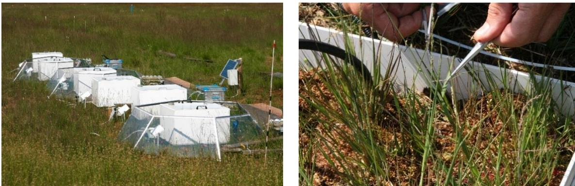
Abb. 39: Probenahme des  $^{13}\text{C}$ -Pulse-Labeling Experiments. Beprobung des emittierten  $\text{CO}_2$  und  $\text{CH}_4$  mit lichtundurchlässigen Hauben (links), Entnahme der Vegetationsproben (rechts). Fotos: Bärbel Tiemeyer.
