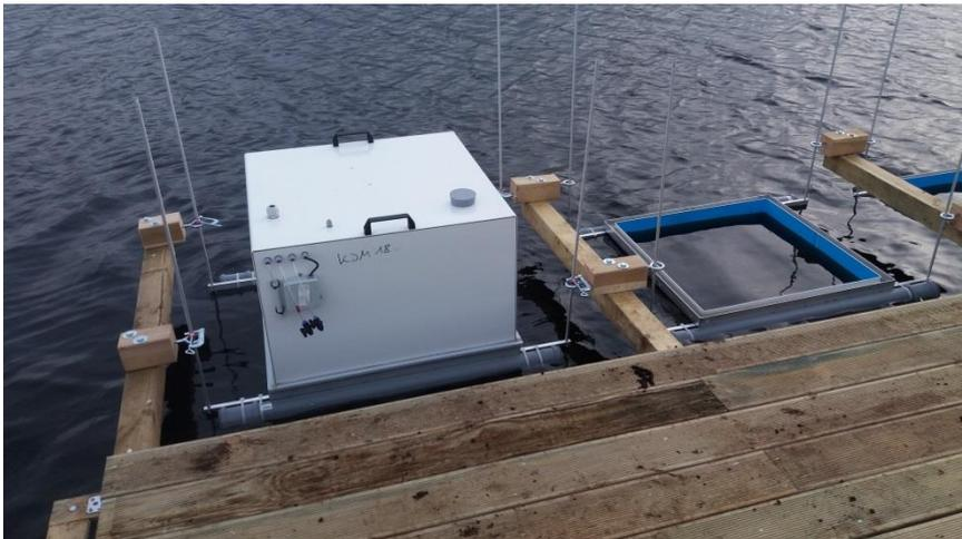
Abb. 38: Steg im Bewässerungspolder im Provinzialmoor mit schwimmenden Rahmen und aufgesetzter Haube zur Messung von Methan- und Lachgasflüssen. Foto: Dominik Düvel.
