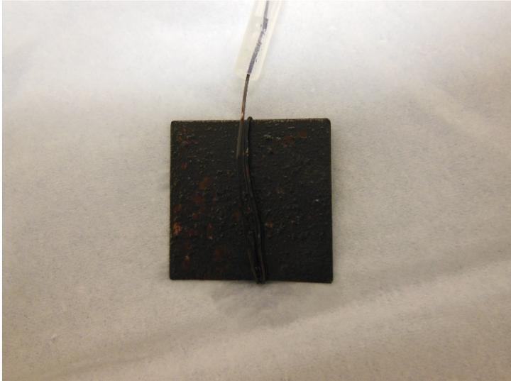
Abbildung 29: Selektive Abtrennung von Pb aus salpetersaurer Strip-Lösung durch Oxidation zu  $\text{PbO}_2$
