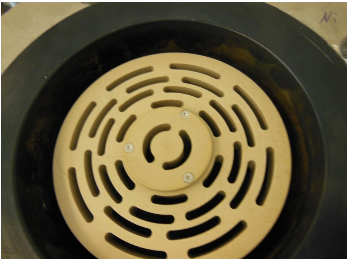
Abbildung 27: Abscheider in Einbaulage in der Messkammer
