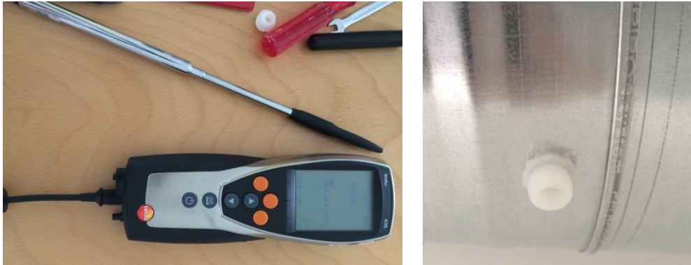
Abbildung 33: links: Strömungsmessgerät, rechts: Messöffnung mit Verschlussstopfen
