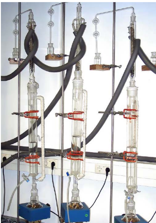
Abbildung 17-4: Perforator-Verfahren gemäß DIN EN ISO 12460-5 (Schwab et al. 2004)
