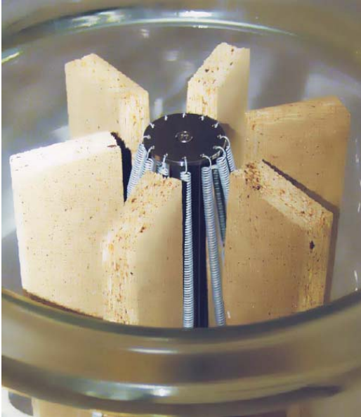
Abbildung 17-7: Exsikkator-Verfahren DIN EN ISO 12460-4 (Schwab et al. 2004)
