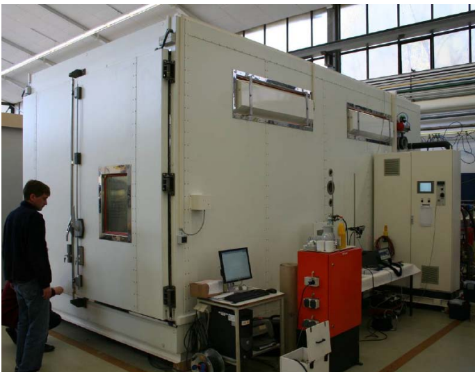
Abbildung 17-1: Prüfkammer-Verfahren gemäß DIN EN 717-1 (Schwab et al. 2004)
