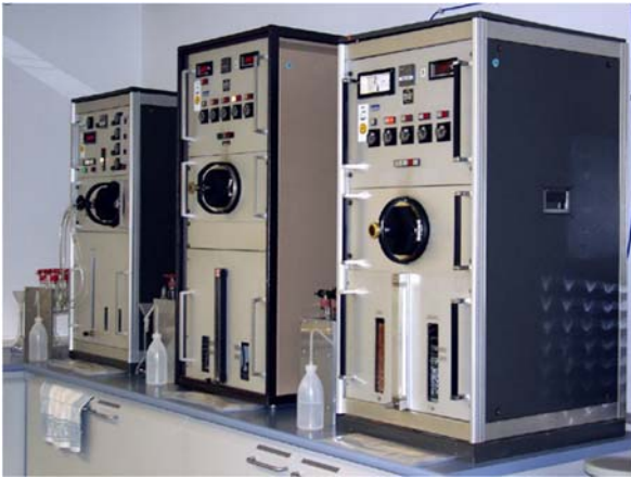
Abbildung 17-5: Gasanalyse-Verfahren gemäß DIN EN ISO 12460-3 (Schwab et al. 2004)
