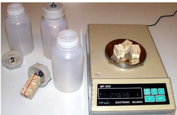
Abbildung 17-6: Flaschen-Methode gemäß DIN EN 717-3 (Schwab et al. 2004)
