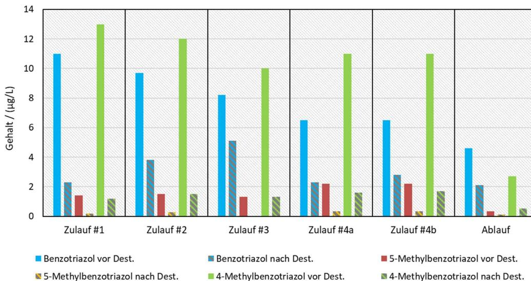
Abb. 50: Gehaltsbestimmungen der drei Benzotriazole zu mehreren Probenahmezeitpunkten aus dem März und April 2019 in Zu- und Ablaufproben mit und ohne Destillation als Probenvorbereitungsschritt.
