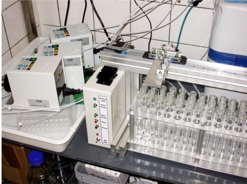
**Abbildung 7** Kleinfiltertest: Zahnradpumpen (links) und Autosampler (rechts)
