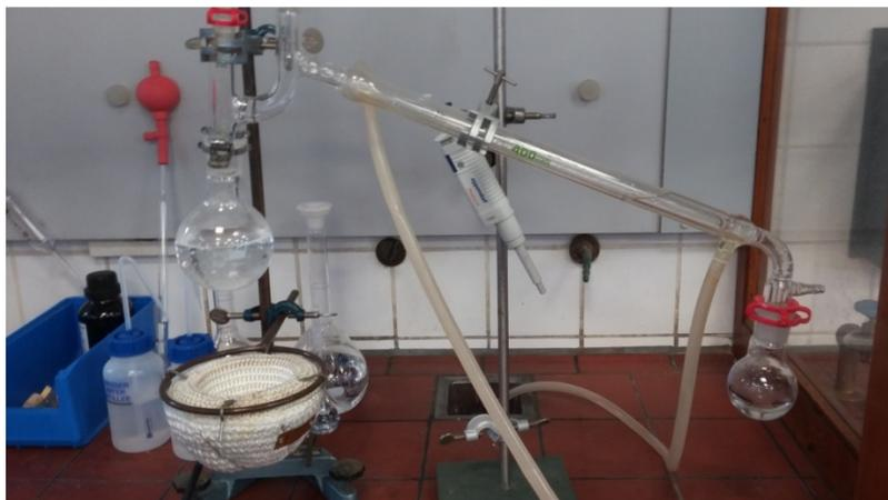
**Abbildung 15** Laboraufbau der Destillationsapparatur zur Bestimmung der Wiederfindung
