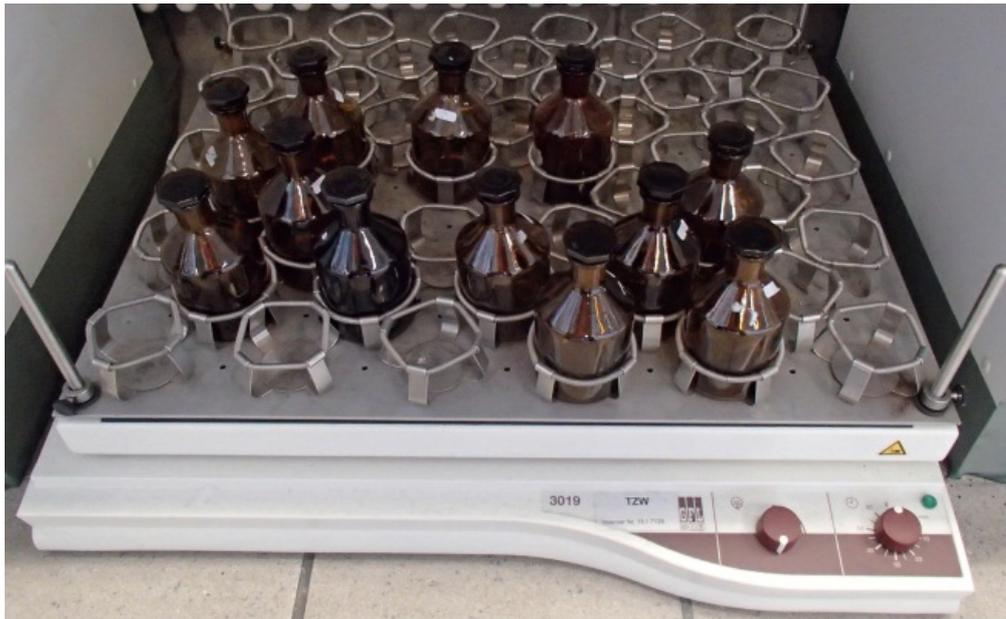
**Abbildung 2** Überkopfschüttler zur Aufnahme von Adsorptionsisothermen
