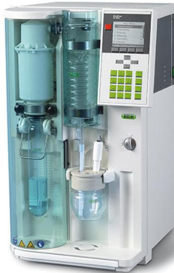
**Abbildung 16** Automatisierte Destillationsapparatur
