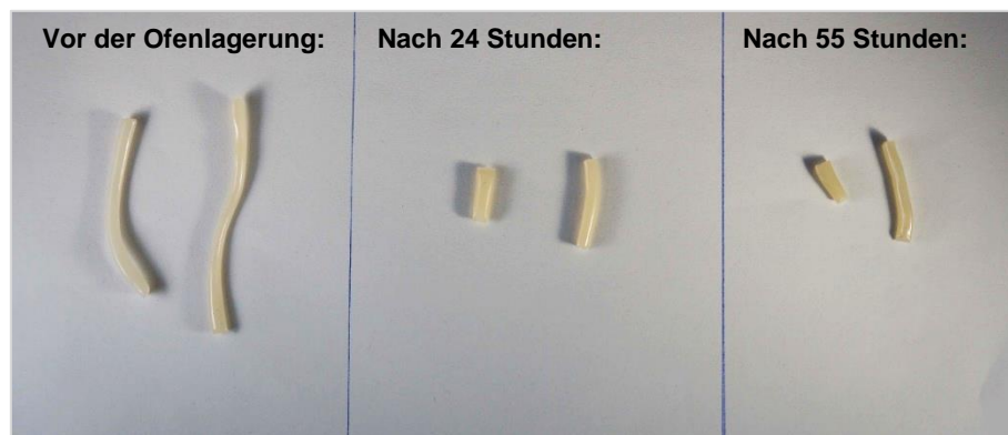
Abbildung 2: Ofentest zur Beurteilung der farblichen Veränderung PA6.10-AO1
