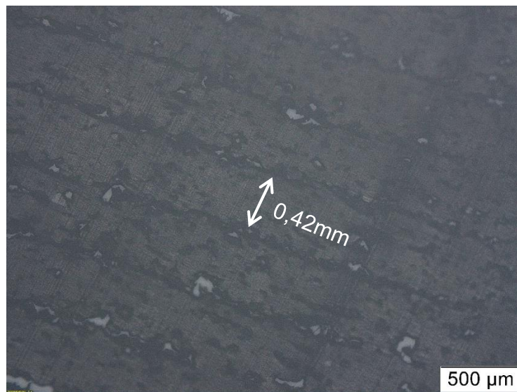
Abbildung 30: Dünnschnittaufnahme einer PBS-Probe
