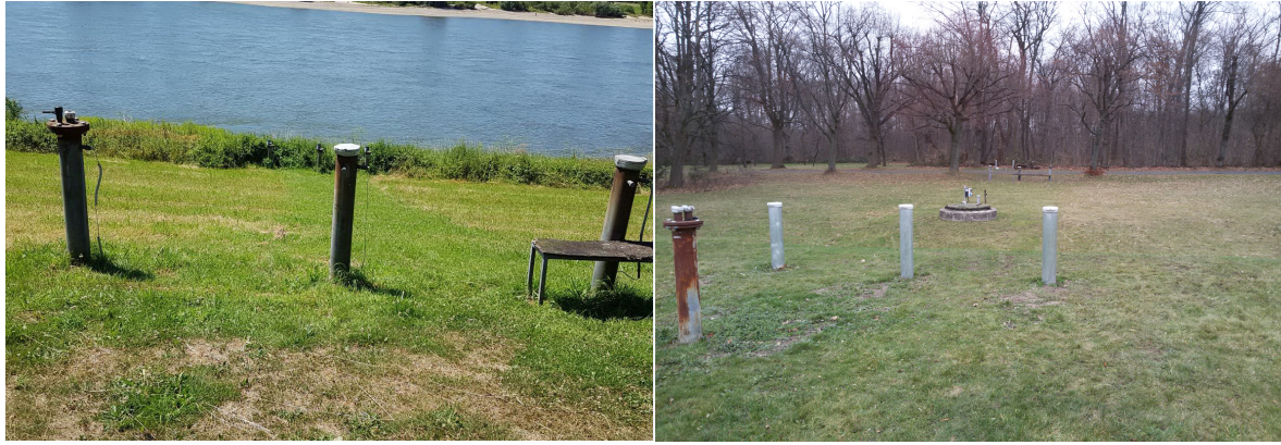
Abbildung 5. Messstellen am Wasserwerkflehe. Links = Grundwassermessstellen B1-3, rechts = D1-3
