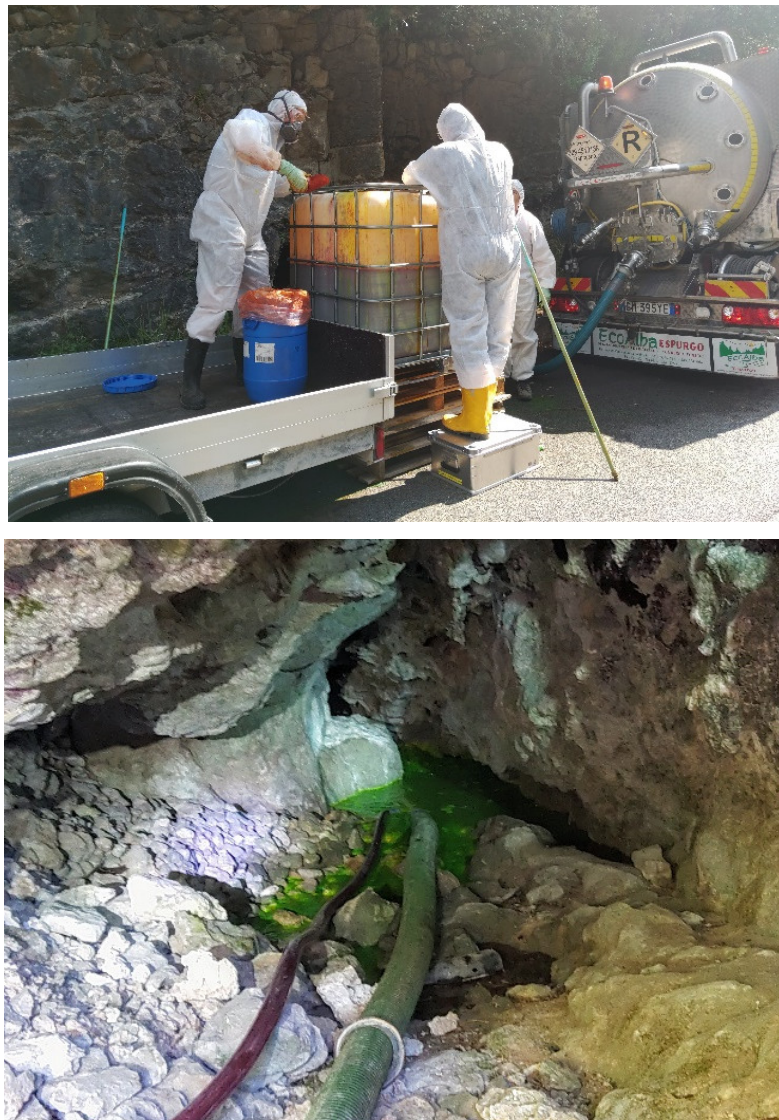
Abbildung 43. Anmischen des Uranins mit Wasser (oberes Bild) und Einleiten des Tracers in die Höhle (unteres Bild).
